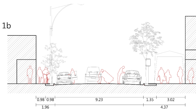
Figura N°17: Perfil de calle tramo 1b
