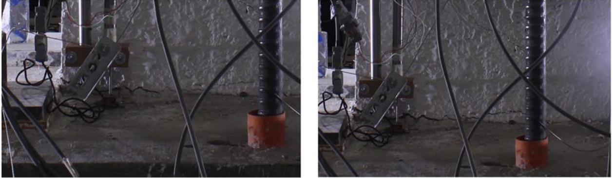
Figura 5.24: Desarrollo de la grieta horizontal en tercer ciclo del 2%(izquierda) y primer ciclo del 2,5%(derecha), ambos desplazamientos en dirección Este.
