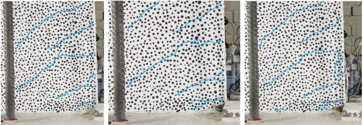
Figura 5.27: Desarrollo de daño del muro en lado Oeste durante Primer(izquierda), segundo (al medio) y tercer(derecha) ciclo del 2,5% en dirección Este.
