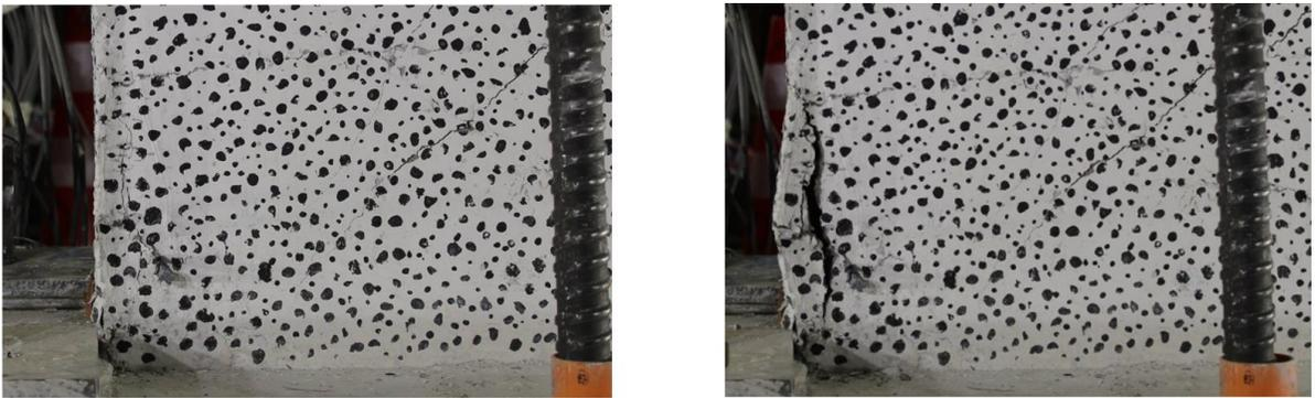
Figura 5.8: Evolución de grieta por pandeo de barra longitudinal en los desplazamientos del tercer ciclo 1,6% (25,00 [mm], izquierda) y primer ciclo 2,00% (32,49 [mm], derecha) en dirección Este ambas.
