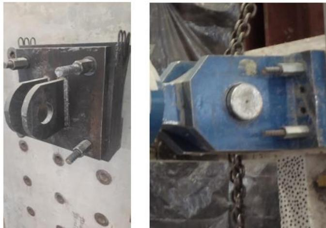
Figura 4.6: Rotulas de conexión del actuador horizontal.
