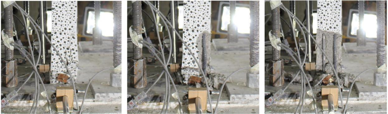
Figura 5.9: Proceso de desprendimiento del hormigón y exposición de las barras longitudinales de borde en los primeros dos ciclos del 2,00% (32,49 [mm]) dirección Este y el tercer ciclo del 2,00% (21,80 [mm]) dirección Oeste, orden de izquierda a derecha.
