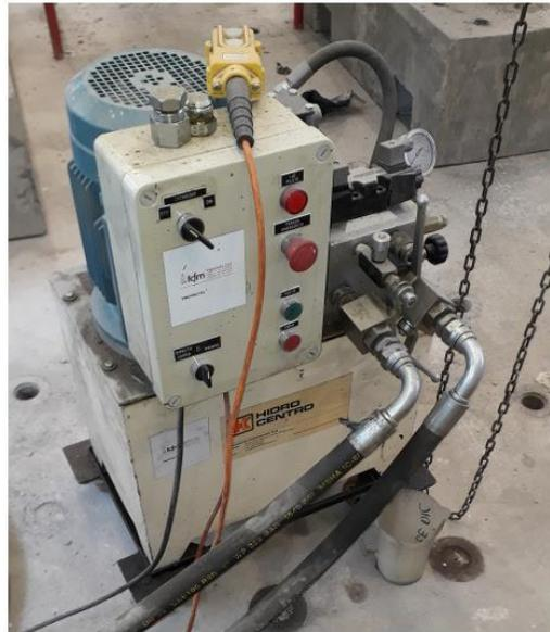
Figura 4.7: Bomba hidráulica del actuador horizontal.
