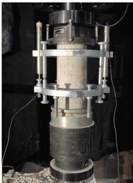
Figura 3.4: Montaje de ensayo a compresión de probetas cilíndricas.
