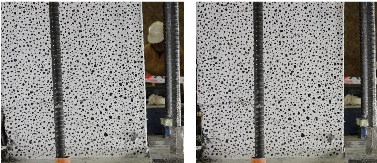
Figura 5.15: Evolución de grietas en desplazamientos peaks Este(izquierda) y Oeste(derecha) durante el tercer ciclo para los desplazamientos de techo de 2,00% (32,49 [mm]) y 2,00% (21,80 [mm]) respectivamente.
