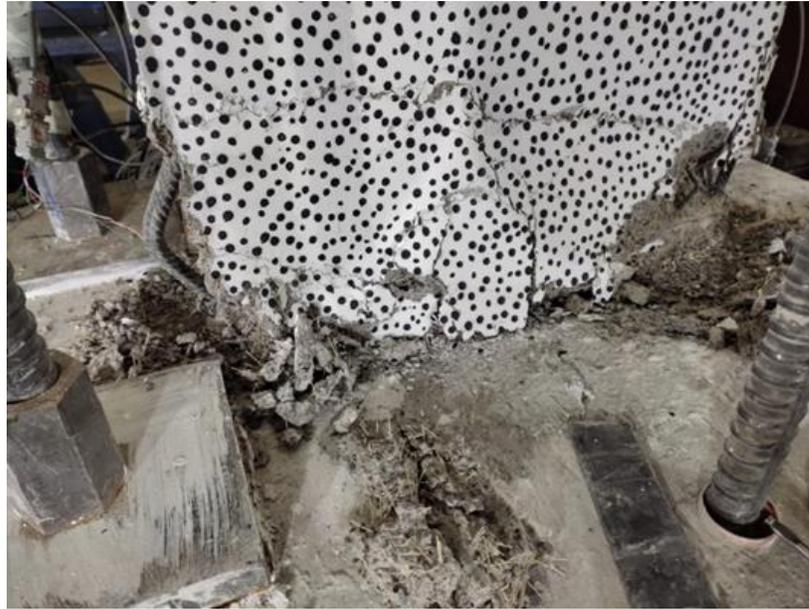
Figura 5.41: Modo de falla – Muro hormigón con fibras PVA.
