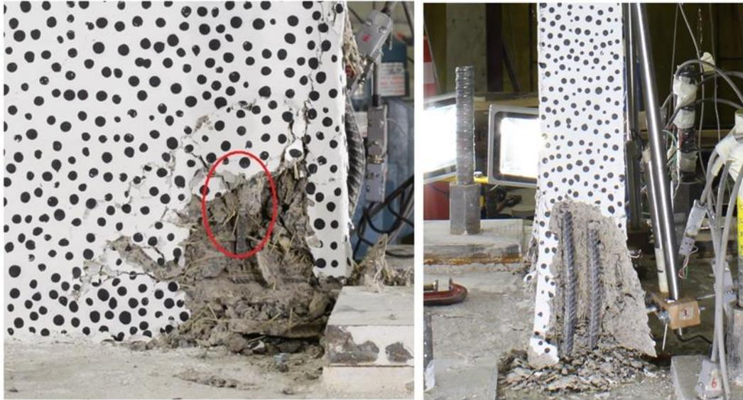
Figura 5.31: Corte de la barra  $\phi 6$  longitudinal e inclinación de barras longitudinales fuera del plano.
