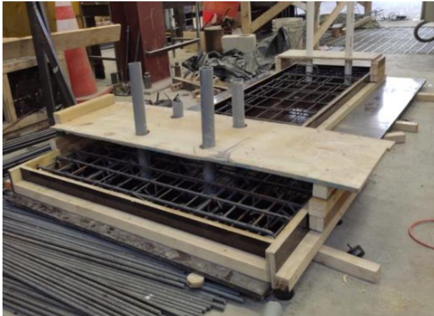
Figura 3.9: Moldaje de muro previo al hormigonado.
