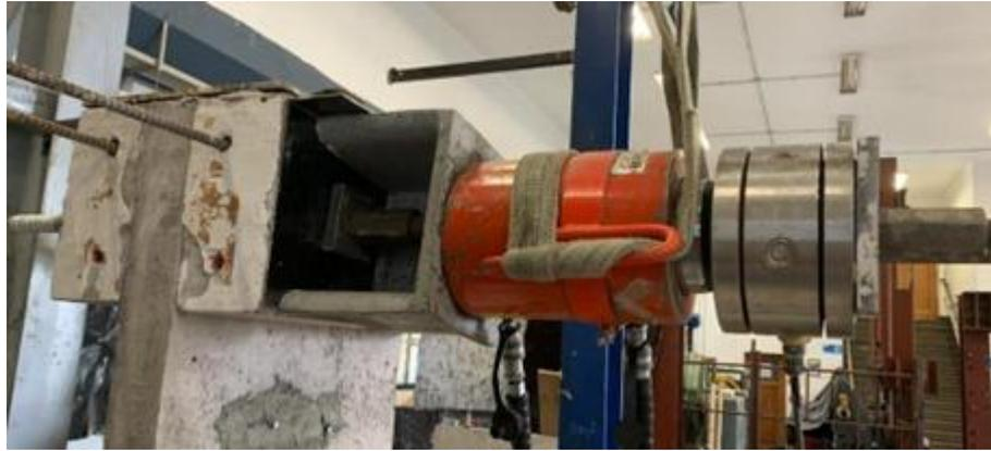
Figura 4.12: Postensado de barras de acero transversales a viga de transferencia.
