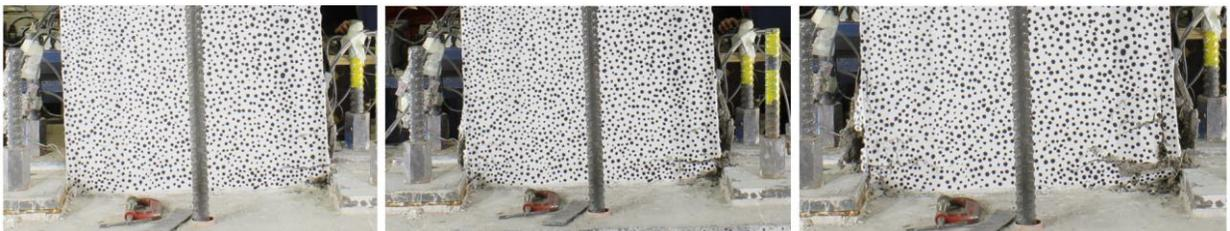
Figura 5.28: Pandeo local de barras longitudinales de borde en cara Este del muro. Primer, segundo y tercer ciclo (de izquierda a derecha) de 3,2% en dirección Este.
