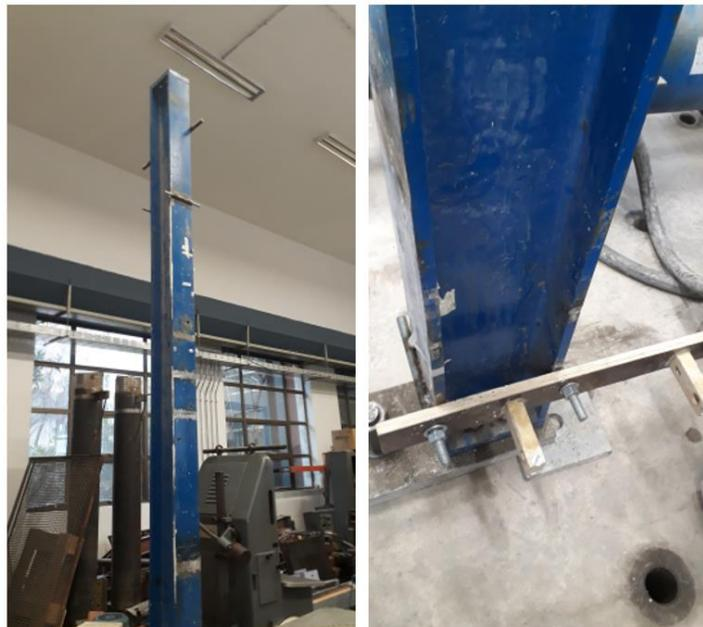
Figura 4.18: Pedestal independiente para los sensores externos a la probeta(izquierda) y el soporte de los sensores en el pedestal(derecha).
