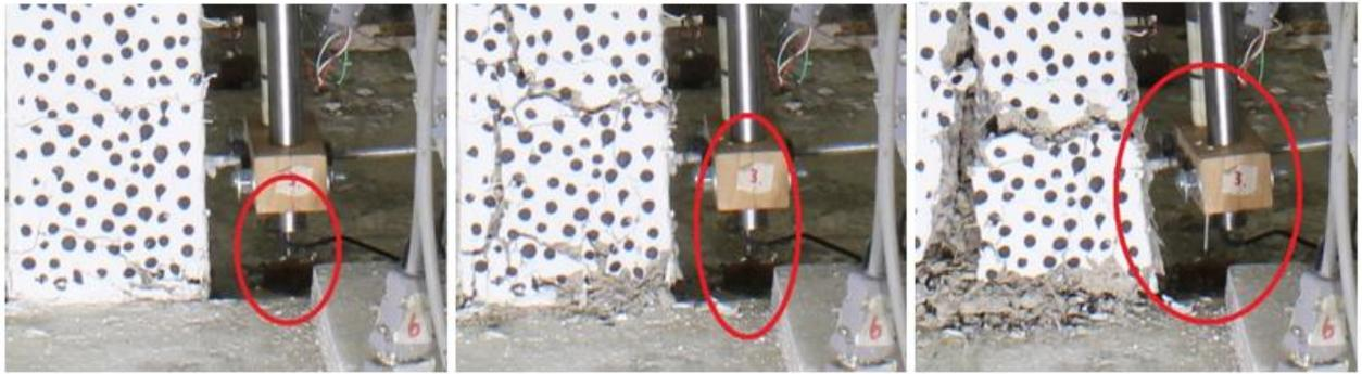
Figura 5.18: Evolución de rotación varilla de LVDT en el primer ciclo del 2,0% y 2,5% en dirección Este, y posición central en el tercer ciclo del 3,2% (de izquierda a derecha)
