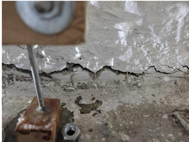
Figura 5.25: Trabajo de las fibras de PVA en el primer ciclo 2,5% en dirección Este.
