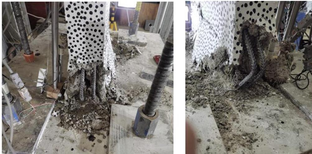
Figura 5.42: Pandeo de barras longitudinales de borde - Muro hormigón con fibras PVA, Vista Oeste (izquierda) y Este(derecha) del muro.
