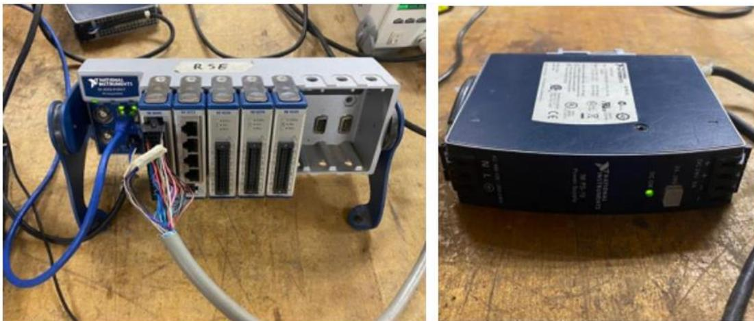
Figura 4.21: Chasis, modulo Adquisición de datos y fuente de poder.
