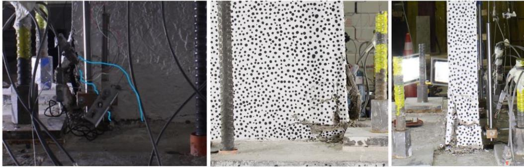
Figura 5.29: Desprendimiento de lado Este del muro por pandeo de barras longitudinales. Vista Sur(izquierda), vista norte (al medio) y vista Este(derecha).
