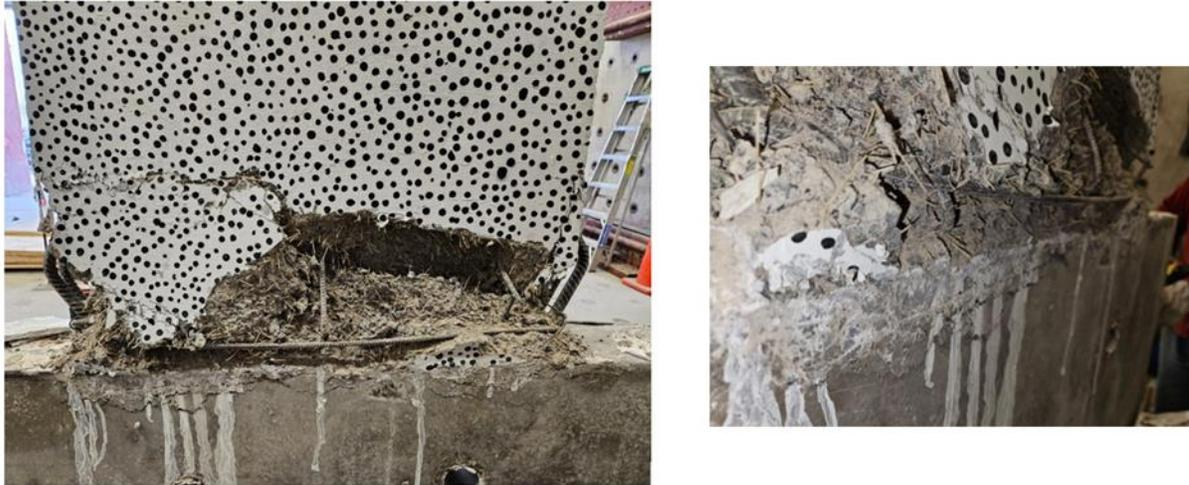
Figura 5.35: Pandeo de barras longitudinales de borde en cara norte del muro post-ensayo.
