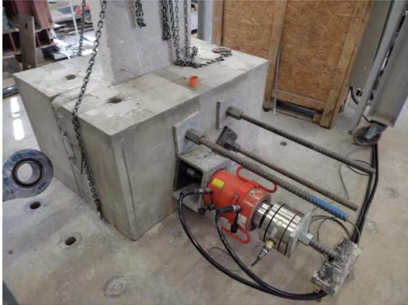
Figura 4.10: Postensado de barras de acero transversales a las fundaciones.
