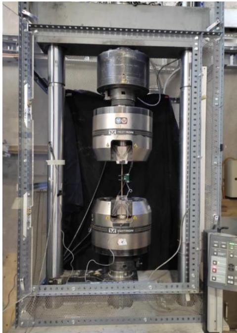
Figura 3.2: Ensayo a tracción de barras de acero.
