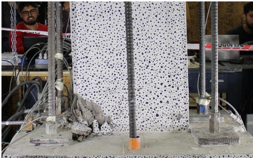
Figura 5.39: Modo de falla – Muro hormigón normal.
