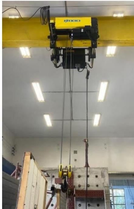
Figura 4.3: Puente de grúa Kixio del laboratorio de estructuras.
