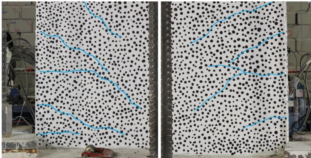
Figura 5.21: Grietas por flexión en el primer ciclo del 1,00% en dirección Oeste(izquierda) y Este (derecha).
