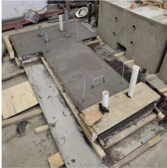
Figura 3.11: Enrasado final en superficie de la probeta.
