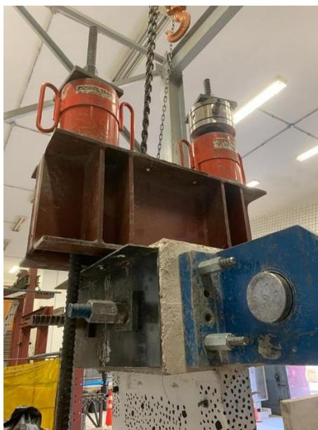
Figura 4.14: Sistema de carga axial.
