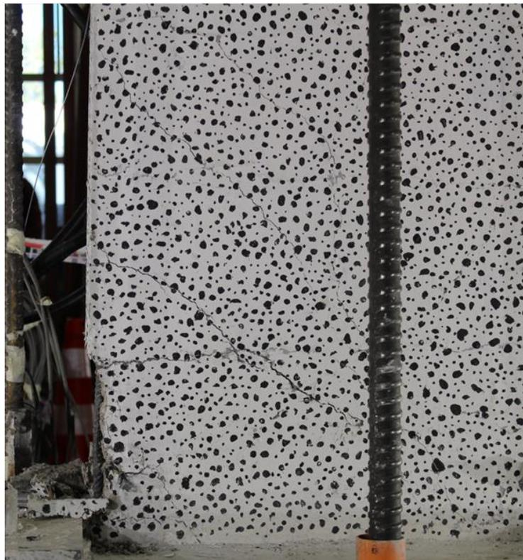
Figura 5.10: Evolución de grietas en el tercer ciclo del 2,00% (21,80 [mm]) en dirección Oeste.
