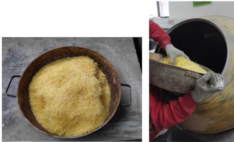
Figura 3.10: Fibra de PVA larga (izquierda) y depósito de Fibras PVA en betonera(derecha).
