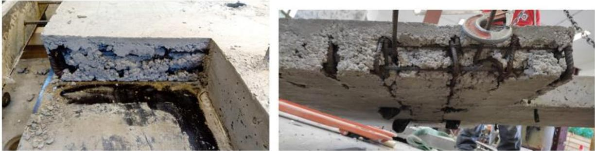
Figura 3.13: Lugares de reparación para probeta de hormigón normal.
