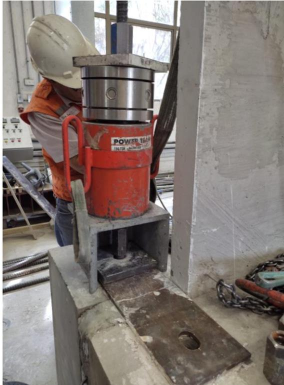
Figura 4.11: Postensado de barras de acero ancladas a losa del laboratorio.
