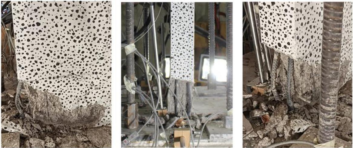
Figura 5.40: Pandeo de barras longitudinales de borde - Muro hormigón normal.
