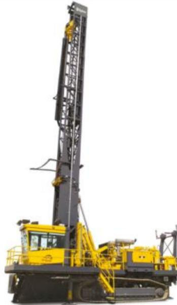
**Figura 2: Equipo de perforación producción PV 271, Epiroc.**
