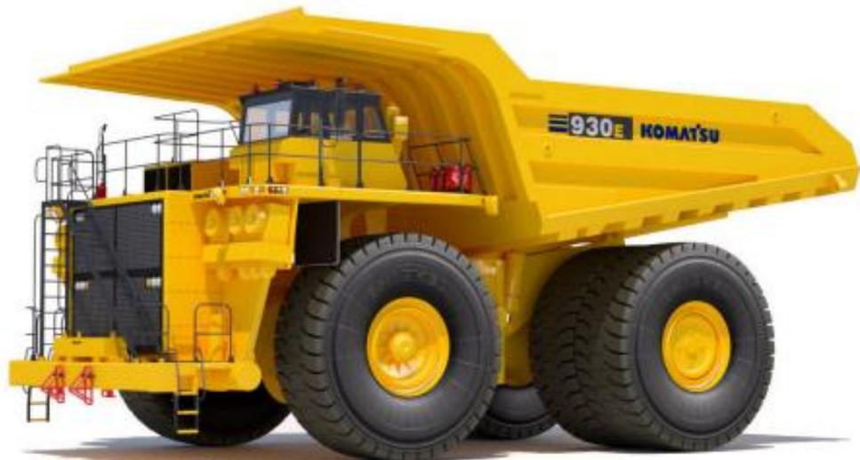
**Figura 4: Camión de extracción Komatsu 930E-4, Komatsu.**
