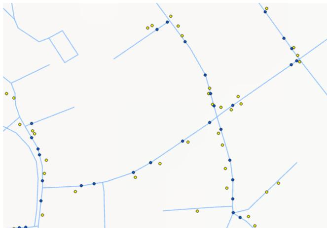
Figura 6.5: Corrección de datos GPS. Los puntos amarillos representan las coordenadas originales y los puntos azules representan las coordenadas corregidas.
