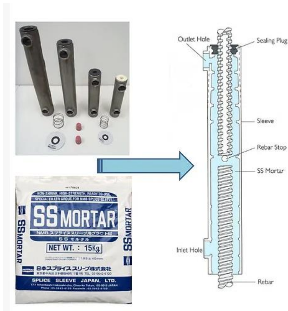
Figura 6-1: Esquema Conectores Splice Sleeves Con Mortero S22.
