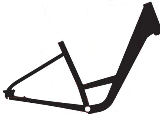
Figura 2.3: Estructura de un cuadro *step through*. Elaboración propia.
