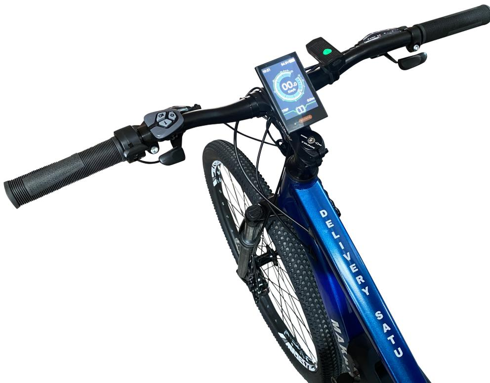
Figura 3.4: Dirección del modelo Delivery Satu de MakanaBikes. Elaboración propia.
