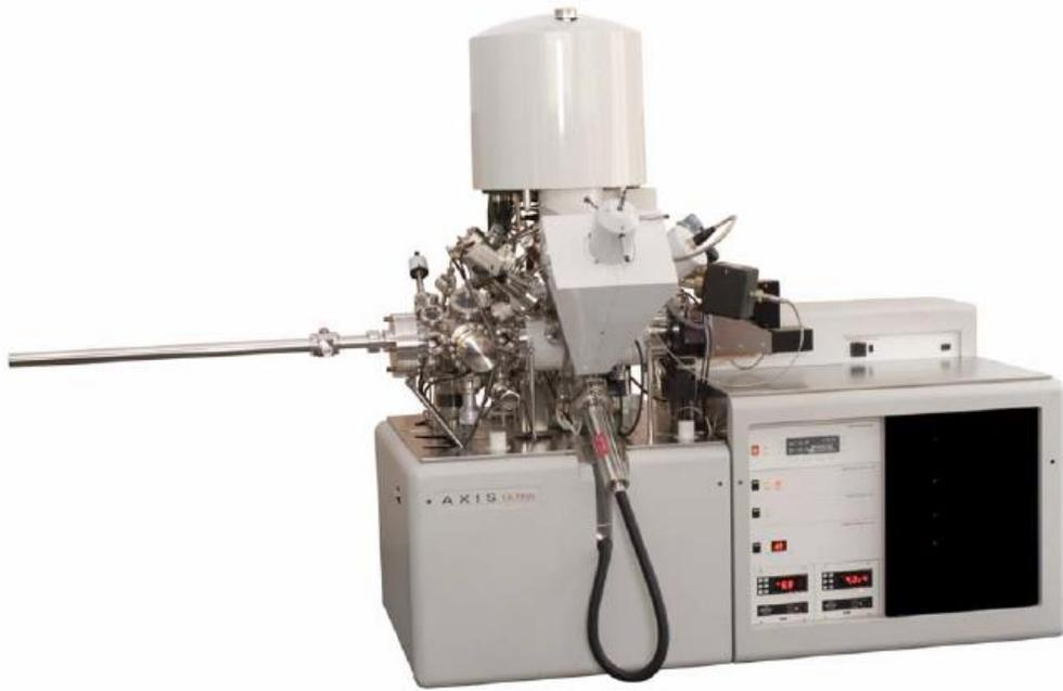
Figura 14 Equipo de espectroscopía de fotoelectrones de rayos-X utilizado para los análisis químicos. (Kratos Analytical Ltd., 2009)
