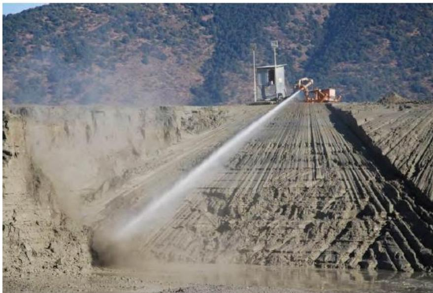
Figura 3: Remoción hidráulica del depósito de relaves Colihues, CODELCO (Henderson, 2013). Monitor operado remotamente a través de una caseta que la conecta a una estación de operación.
