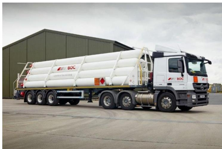
Figura A.2: Camión Tube Trailer [13].
