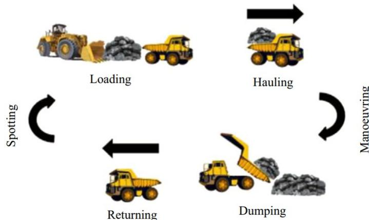
Figura 3.4: Esquema general típico de operación de camiones CAEX en mina. Obtenido de [34].
