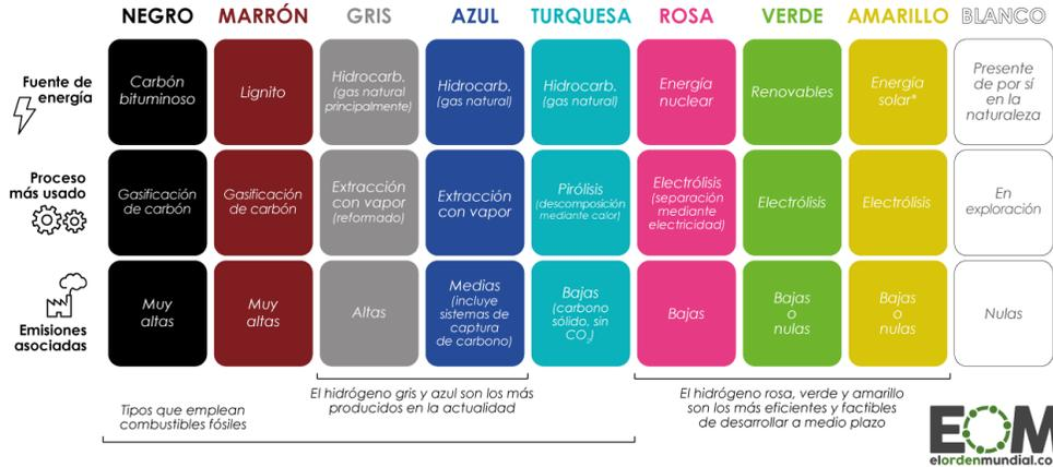
Figura 1.2: Tipos de hidrógeno según su método de producción [5].
