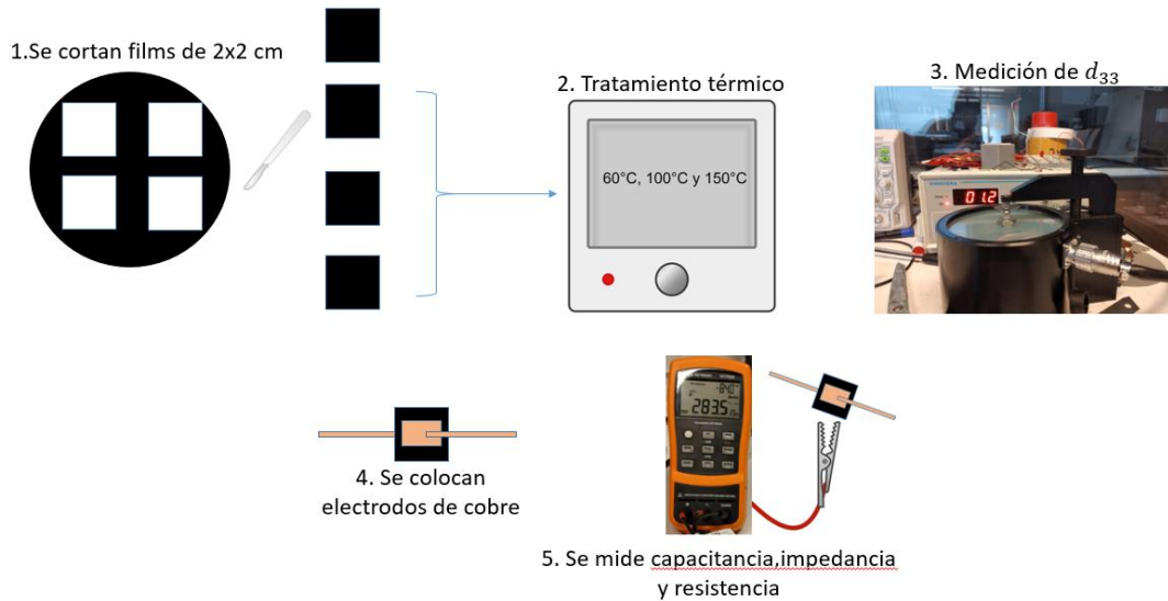
Figura 49: Esquema de medición de coeficiente piezoeléctrico y propiedades eléctricas.
