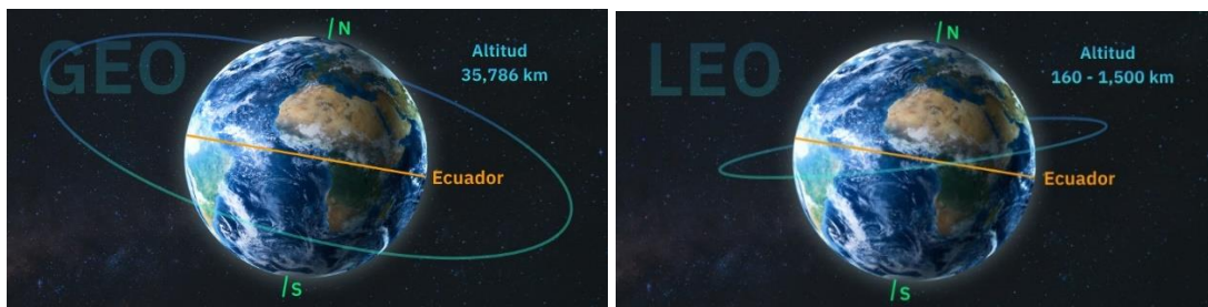
Figura 2-12: Izquierda: Órbita geostacionaria (GEO). Derecha: Órbita terrestre baja (LEO).
