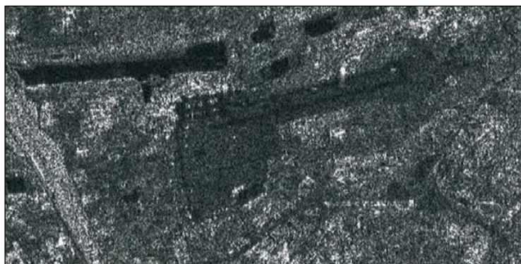
Figura 2-33: Efecto speckle en una imagen SAR detectada en Italia mediante satélite ERS-2. Fuente: Ferreti et al., 2007.
