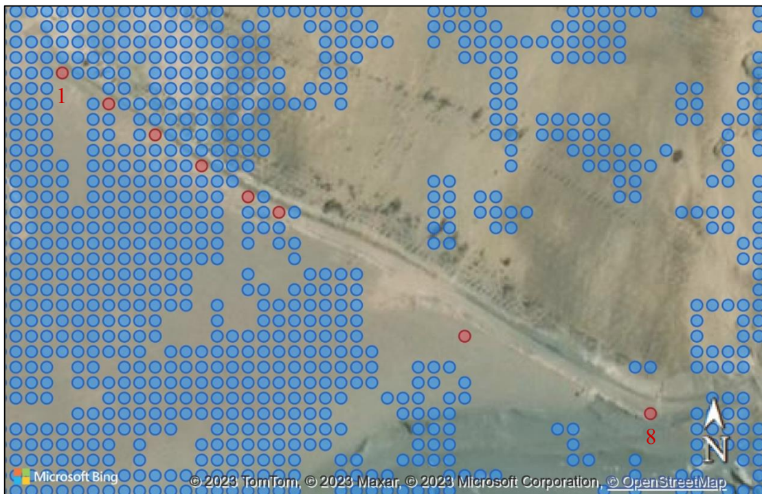
Figura 5-18: Depósito “Ojancos 2”: Puntos de medición al realizar combinación de órbita ascendente con órbita descendente. Fuente: Elaboración propia con Microsoft Power BI.
