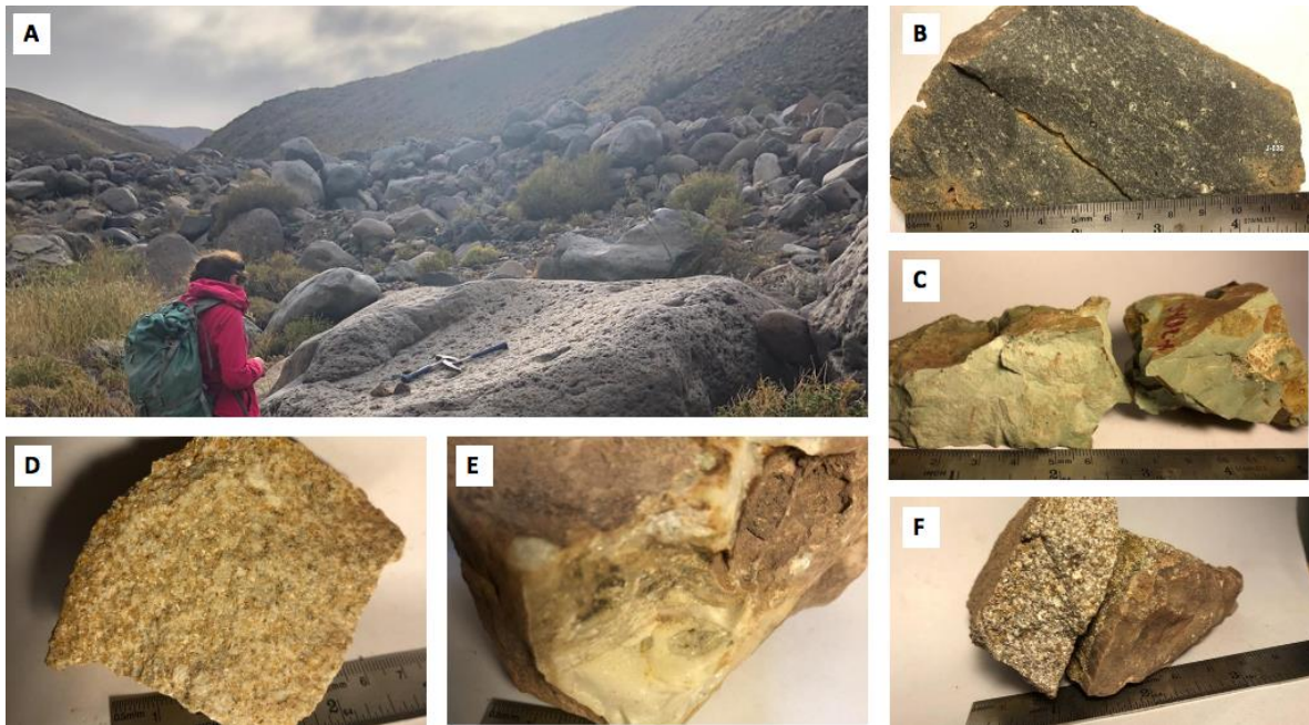
Figura 16: Fuente J-4 (A) Vista general (B) Basalto (C) Lutita (D) Toba silicificada (E) Sílice (F) Arenisca
