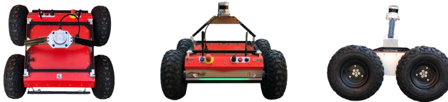
Figura 5.10: Robot Panther con montaje de sensor Ouster OS0 en mundo real.
