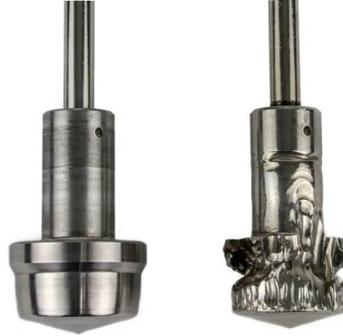
Figura 2.11: A la derecha se muestra un obturador nuevo, a la izquierda otro idéntico, pero luego de haber sido sometido a condiciones de *flashing* [18].
