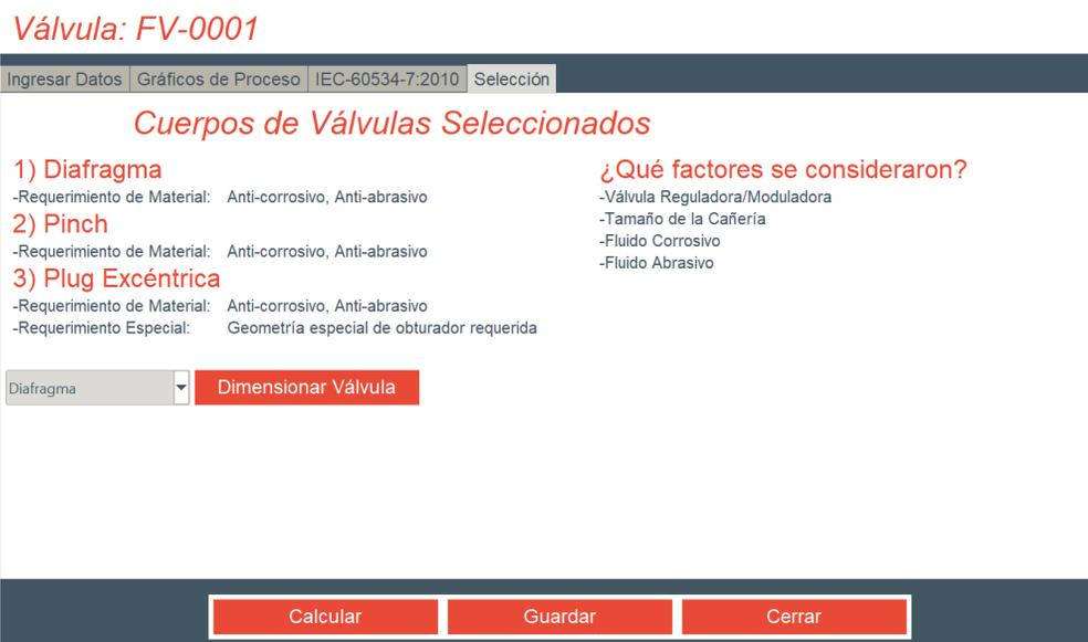
Figura 4.2: Captura de la pantalla de selección del cuerpo de válvula del prototipo de herramienta de software.
