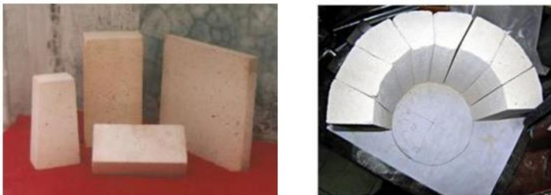
**Figura 13. Formas de ladrillos refractarios prefabricados (GARCÍA, 2014)**
