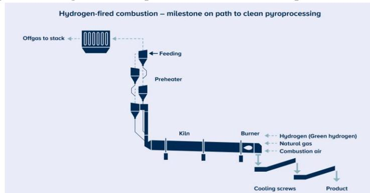
Figura 2-15: Esquema de funcionamiento de horno rotatorio (FLSmidth, 2023)
