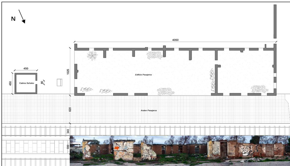
**Figura 10. Planta actual del edificio de pasajeros. También podemos ver la cabina de señales a la izquierda, así como el detalle de andenes por el norte. En la esquina inferior derecha se observa parte del estado actual de la Estación. Fuente: Jiménez et. al. 2012, con redefiniciones y precisiones métricas de andén y rieles a partir de la presente investigación.**
