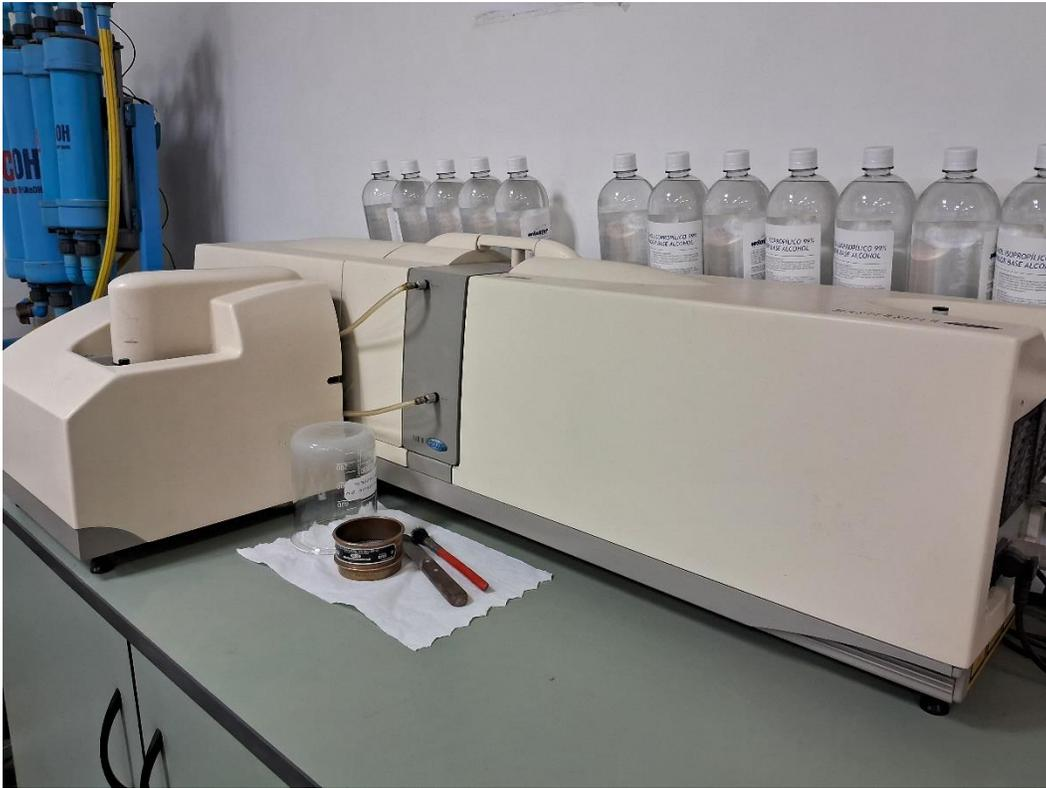
Figura 1.4 Granulómetro Mastersizer 2000 a la derecha junto con el dispositivo accesorio HydroG a la izquierda, utilizado para la medición de granulometría de los suelos.
