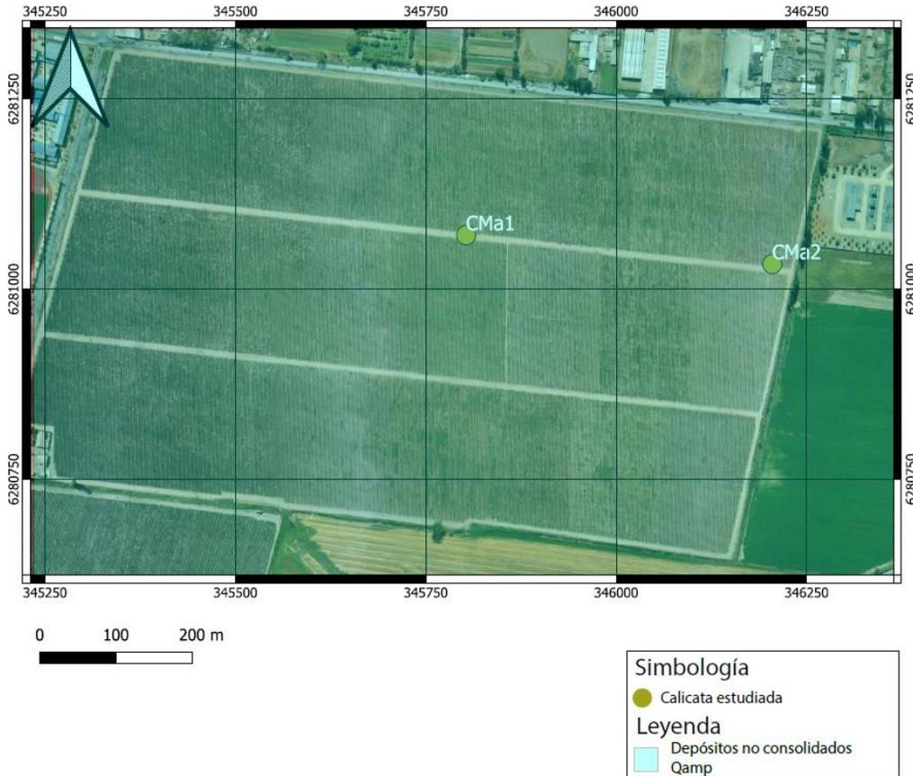
Figura 2.5 Calicatas excavadas en la viña Mariscal, nuevamente el transparente color de fondo indica que la viña se ubica en la formación de depósitos no consolidados Qamp asociados a los abanicos aluviales del norte del río Maipo.
