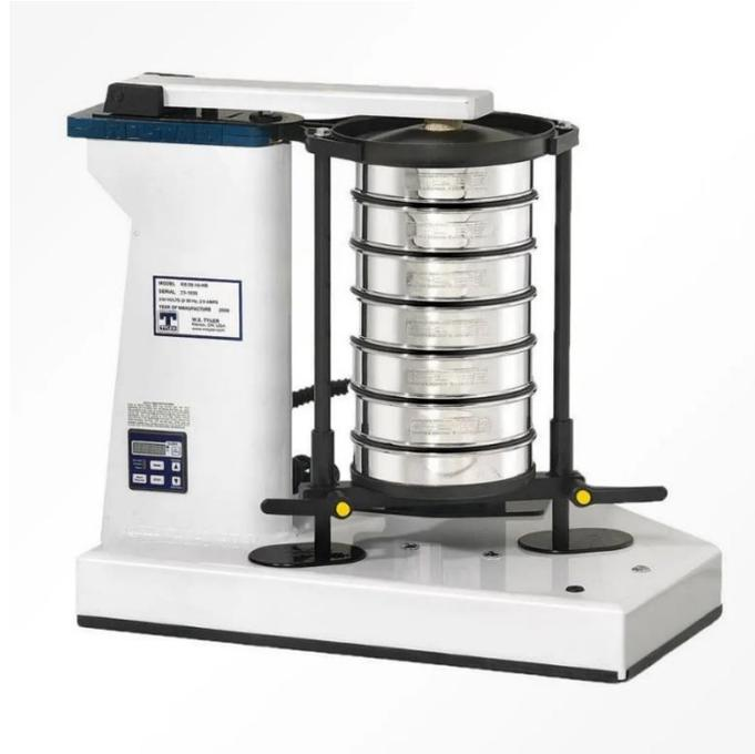
Figura 1.7 Agitador mecánico marca W.S. Tyler modelo Ro Tap 8" RX-29 con capacidad de siete tamices de 8", utilizado para el tamizaje de esta investigación.
