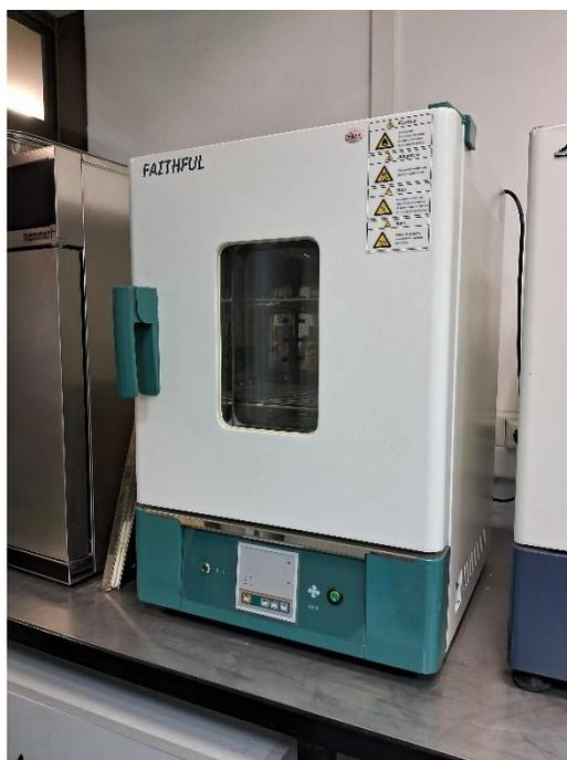
Figura 1.5 Horno de secado de 65 litros de aire forzado para muestras de laboratorio de marca Faithful, con modelo de serie WGL-65B, utilizado para el secado de muestras a baja temperatura.
