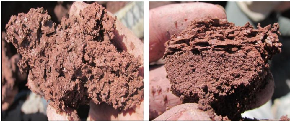
**Figura 7.** Rasgos del perfil del sitio MP02. A la izquierda, presencia de cutanes en horizonte Bt a los 73-103 cm. A la derecha, límite abrupto entre horizontes Bt<sub>4</sub> (122-138 cm) y B<sub>3</sub> (139-160+), en donde se observa claramente el cambio de estructura de cuña a granular.
