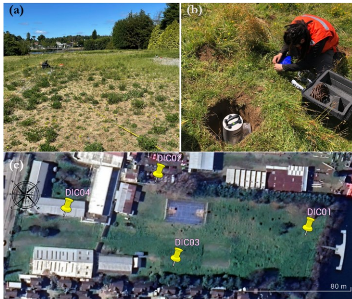
Figura 35 – Campaña de exploración. A) Arreglos 2D Trominos. b) Instalación de sensores banda ancha. c) Esquema en planta de localización de equipos banda ancha.
