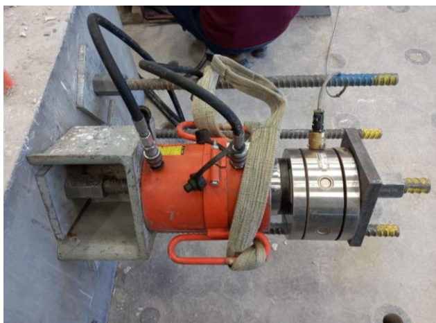
Fig. 11 Sistema de postensado de la fundación con la probeta.
