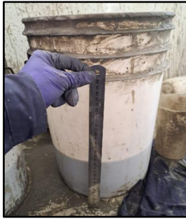
Figura 10.18. Medición de altura del fluido contenido en la tineta para determinar el volumen de la muestra.
