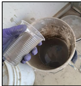
Figura 10.22. Desecho del relave con modificador reológico y floculante en la tineta de residuos para posteriormente ser bombeada hacia el depósito de relaves.
