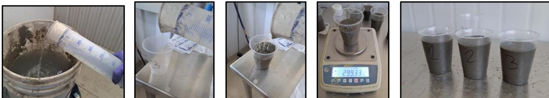
Figura 5.7. Procedimiento de descarte de sobrenadante y pretratamiento reológico.
