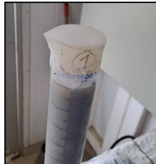
Figura 5.3. Se coloca papel Parafilm en la parte superior de la probeta, de modo que cuando se invierta la probeta no se derrame el contenido de esta.
