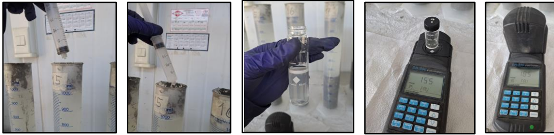
Figura 5.5. Procedimiento para la medición de turbidez en el colorímetro.
