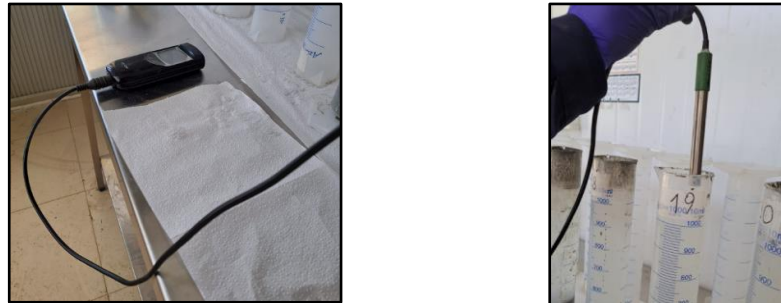
Figura 5.6. Medición del pH del sobrenadante.
