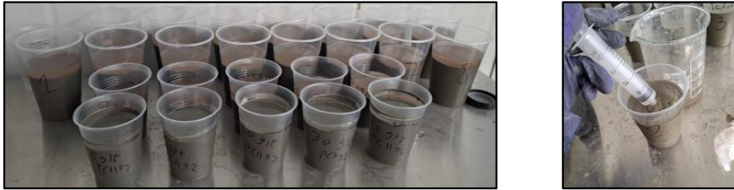
Figura 10.20. Pretratamiento de la muestra para el análisis reológico.
