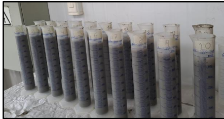
Figura 5.2. Considerando el caso de N=20 , se agrega pulpa hasta los 1000 [mL] de la probeta desde la probeta n°20 hasta la n°1 en orden.
