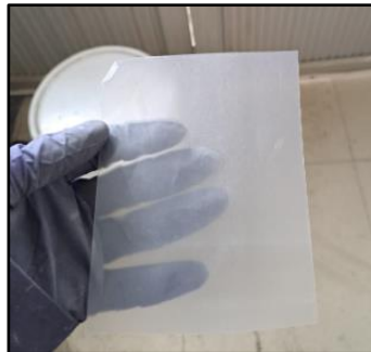
Figura 5.3. Se coloca papel Parafilm en la parte superior de la probeta, de modo que cuando se invierta la probeta no se derrame el contenido de esta.
