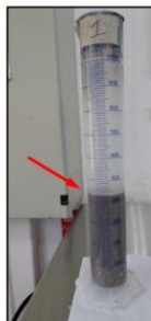
Figura 5.4. A las dos horas se registra el volumen de la pulpa compacta.
