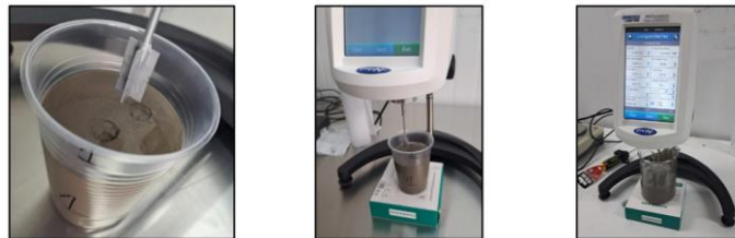
Figura 5.9. Exhibición de la realización de las pruebas reológicas en el reómetro.
