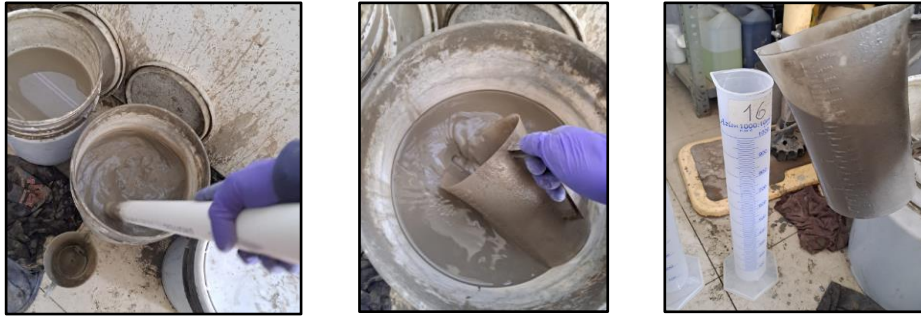
Figura 10.17. Exhibición del proceso de homogenizar la muestra de relave y agregarla a la probeta para la medición de su densidad.
