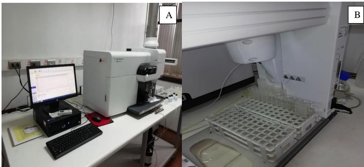
**Figura 10.** Medición de nutrientes en tejido vegetal y solución nutritiva en tratamientos acuapónico (Ap) e hidropónico (Hp). (A) Espectrómetro de emisión atómica por plasma de microondas. (B) Inyección de estándares para establecer márgenes de medición de macronutrientes.
