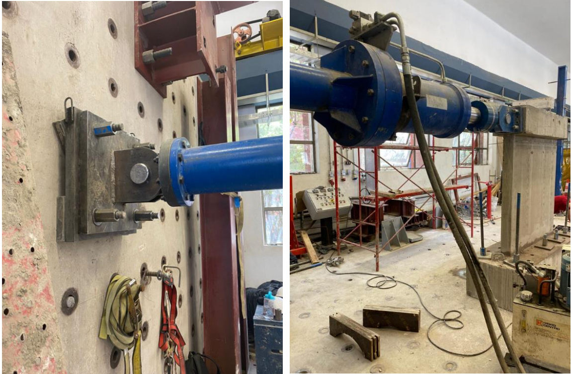
Figura 4.19 : Actuador hidráulico colocado en posición.
