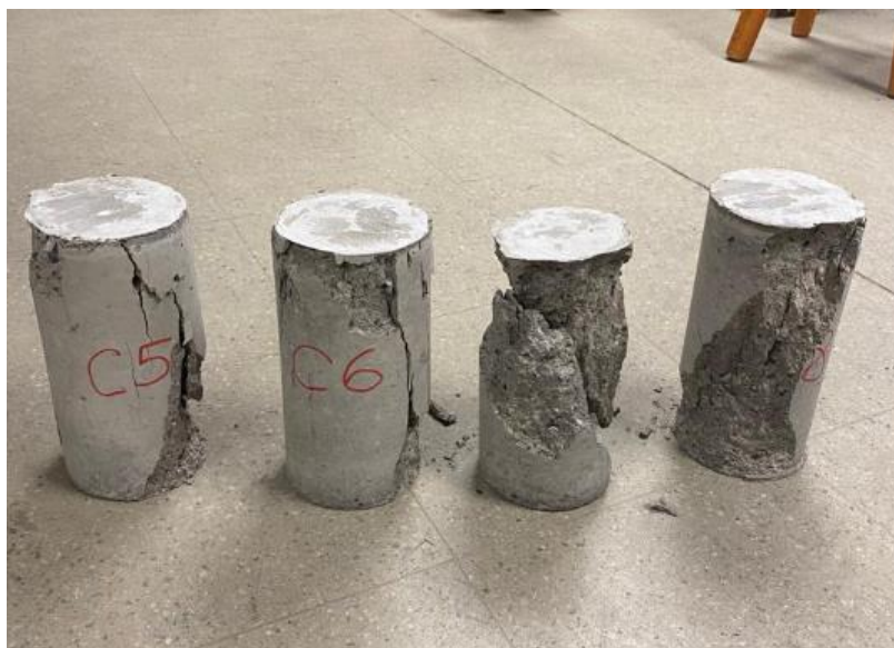
Figura 3.14 : Set de probetas cilíndricas después de ensayo de compresión.
