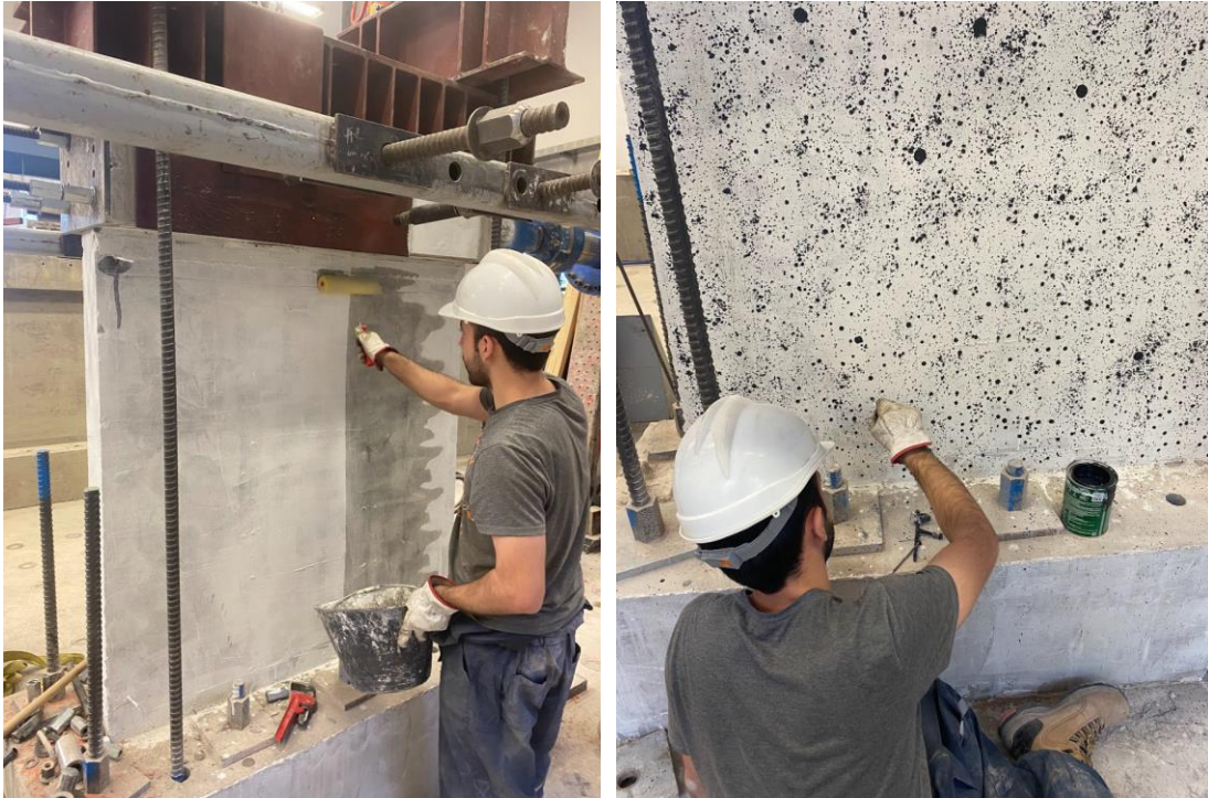
Figura 4.25 : Pintado del muro con cal y pintura negra para los puntos de fotogrametría.
