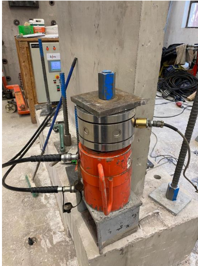
Figura 4.20 : Postensado de barras externas.
