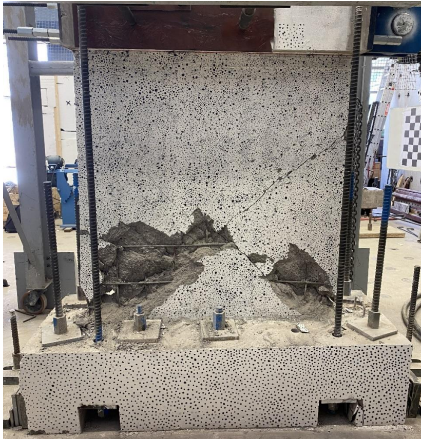
Figura 5.6 : Vista final desde el lado norte del muro convencional.
