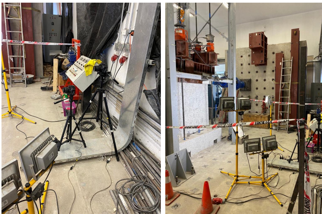
Figura 4.26 : Disposición de cámaras y focos para capturar imágenes de fotogrametría.
