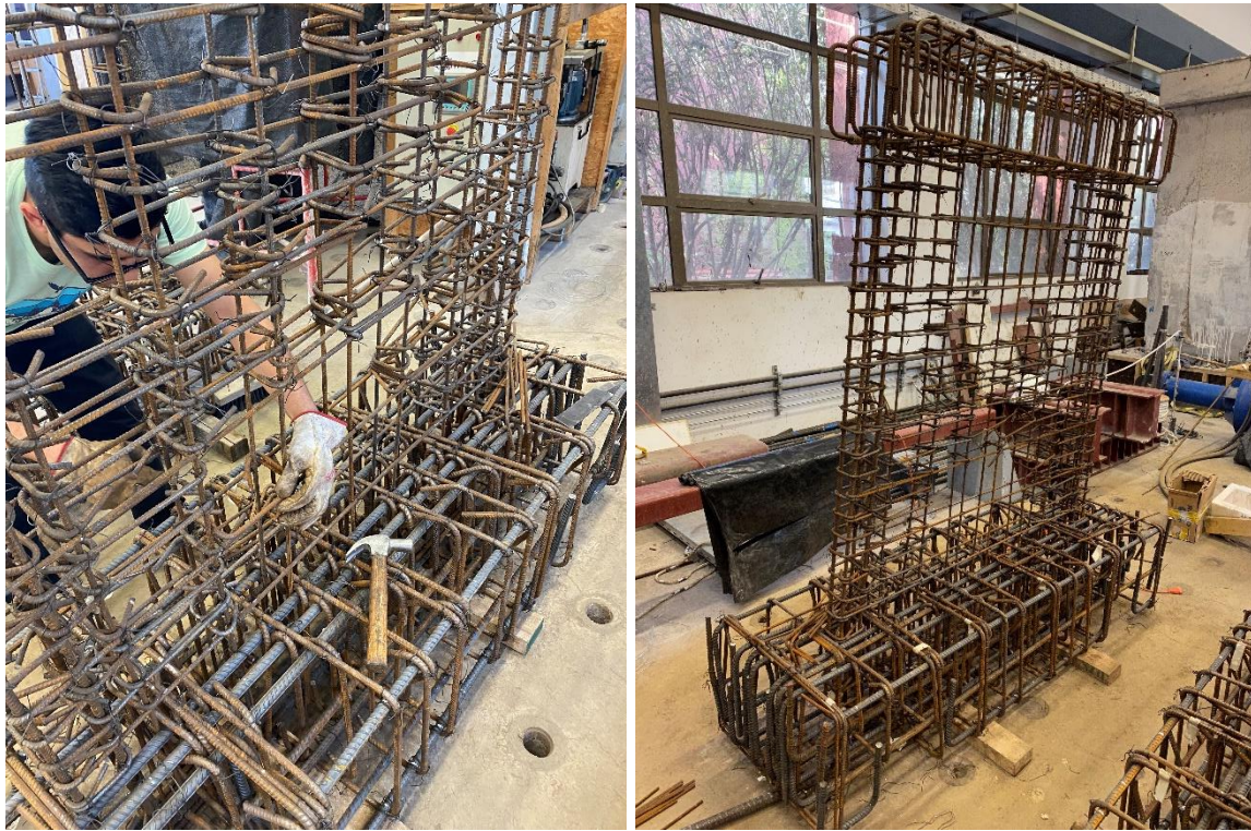
Figura 3.6 : Estribos localizados en la diagonal.
