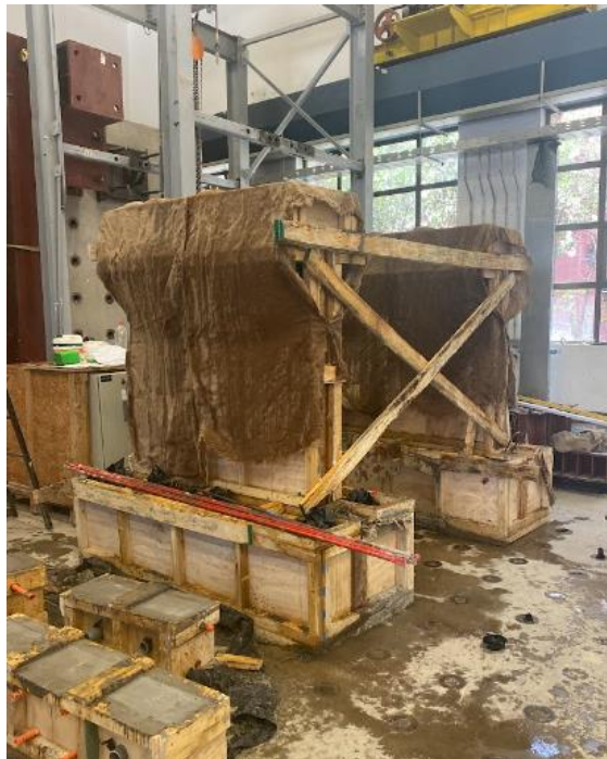
Figura 4.14 : Proceso de regado de probetas.
