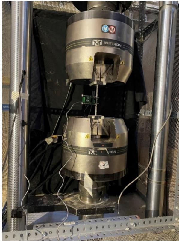
Figura 3.7 : Extensómetro colocado en la barra de acero durante el ensayo a tracción.
