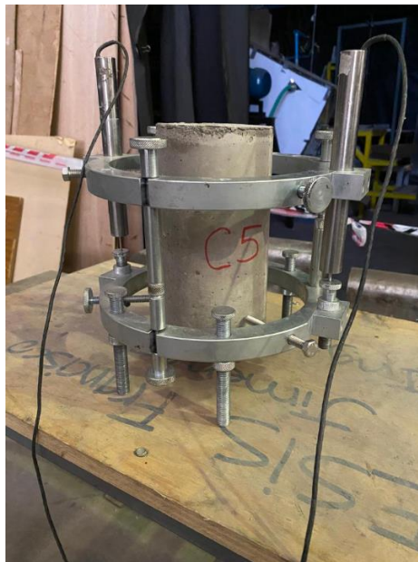
Figura 3.12 : Sensores LVDT colocados en cilindro a ensayar a compresión.
