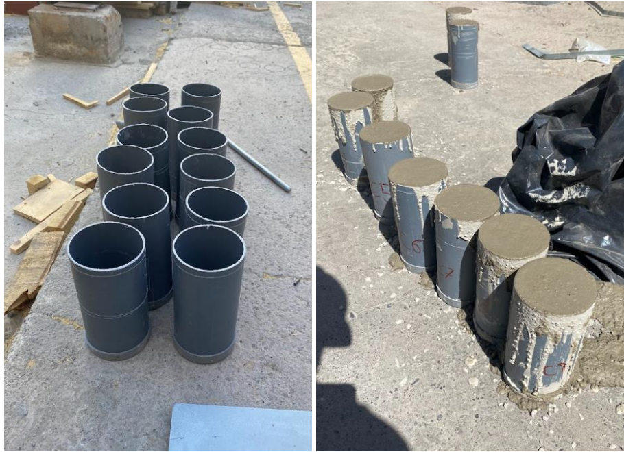
Figura 3.11 : Cilindros de PVC antes y después de verter el hormigón.
