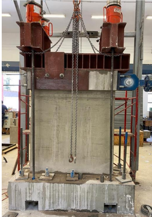
Figura 4.23 : Sistema de carga axial.
