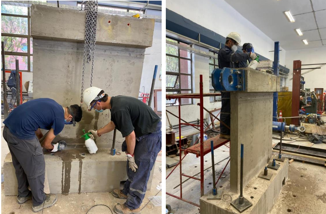
Figura 4.17 : Desbaste de muros.
