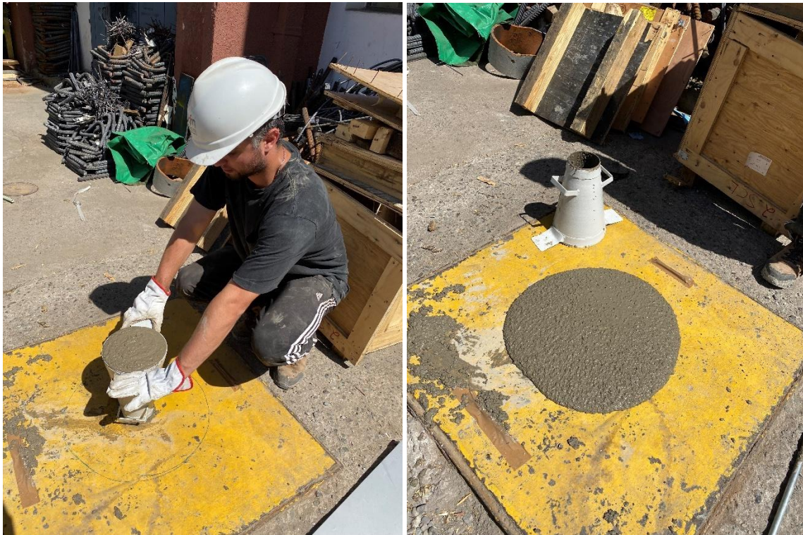
Figura 3.15 : Ensayo de extensión de flujo.
