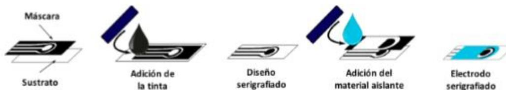
**Figura 5.** Representación general de la elaboración de un electrodo serigrafiado.
