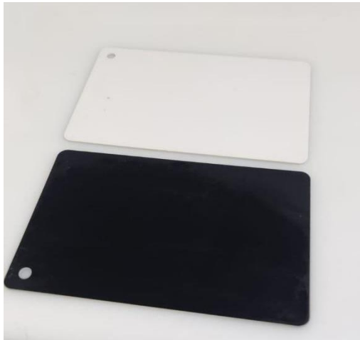
Figura 9: Tarjetas de calibración fotográfica Opteka, ocupadas como fondo blanco y negro para medición del TP.
