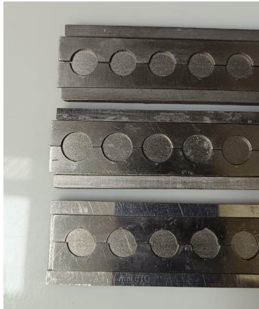
Figura 7: Matrices de acero inoxidable, de 0,5 mm (abajo), 1,0 mm (medio), y 1,5 mm (arriba).
