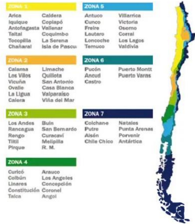
Figura 31: Clasificación de Zonas Térmicas sobre el territorio Nacional. Definido desde la NCh 1079
