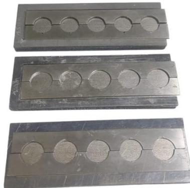
**Figura 9:** Matrices divididas de acero inoxidable 0,5, 1,0 o 1,5 mm de espesor y 11 mm de diámetro, en orden de abajo hacia arriba.
