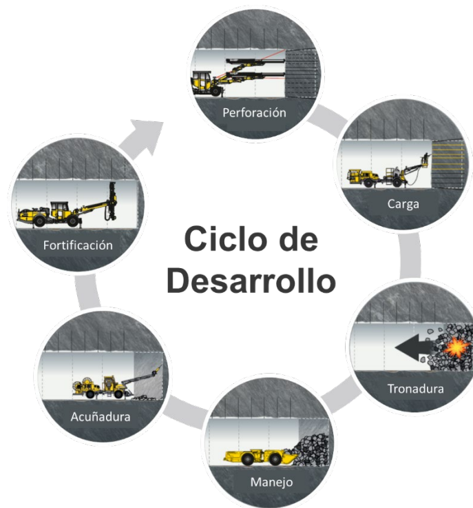
Ilustración 3. Proceso productivo desarrollo Minera Florida. Fuente: Manual de operaciones Minera Florida.
