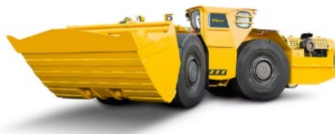
Cargadores de bajo perfil (LHD SCOOP TRANS1030 EPIROC).
