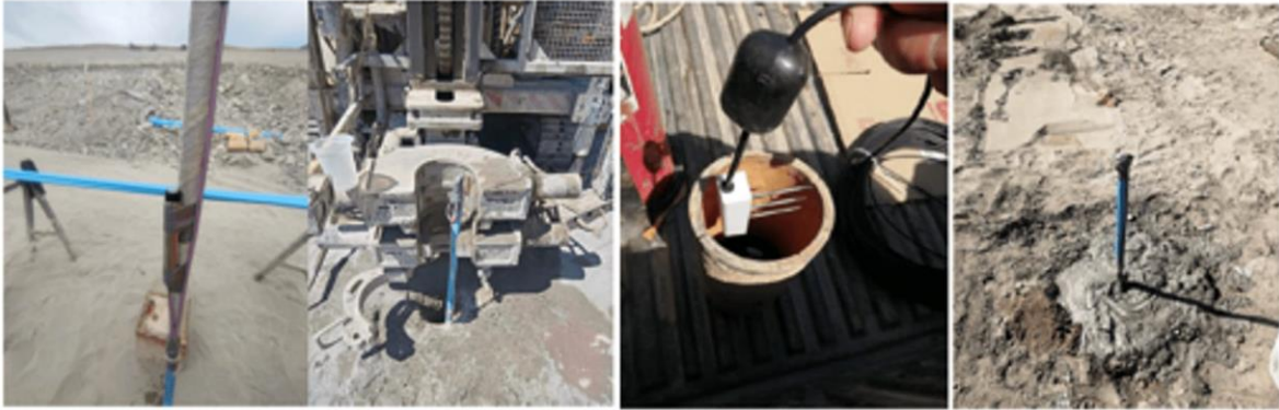
FIGURA 9. FOTOS DE LA INSTALACIÓN DEL SENSOR DE HUMEDAD EN EL POZO N 2.
