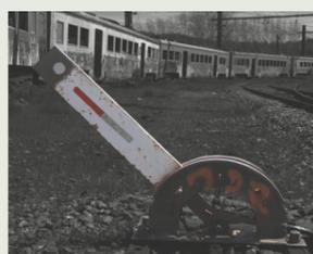
Palanca manual para intercambio de pista de ferrocarril.
