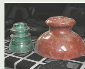
Aislante eléctrico de vidrio para locomotora eléctrica.
