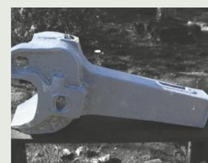
Acoplador automático utilizado en ferrocarril de acoplamiento.
