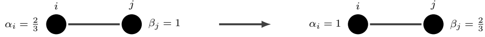
Figura 2.9: Al terminar la ejecución, si j se emparejó directamente a i , ij queda en el matching final y todos los vecinos de j fueron emparejados, se intercambian los valores de \alpha_i y \beta_j .
