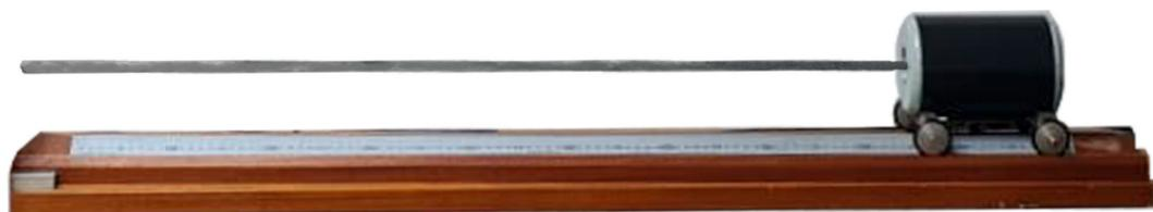
Figura 105. Carro que se introduce en el tubo en busca de la onda sonora. Fuente: (Elaboración propia, 2022).
