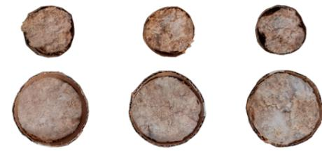
Figura 111. Muestras de aserrín, 30 mm, 50 mm, 70 mm, respectivamente. Fuente: (Elaboración propia, 2022).
