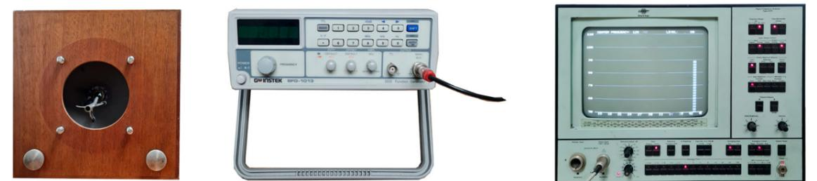
Figura 16. Parlante, oscilador de frecuencia, monitor que obtiene los datos, de izquierda a derecha respectivamente. Fuente: (Elaboración propia, 2022).
