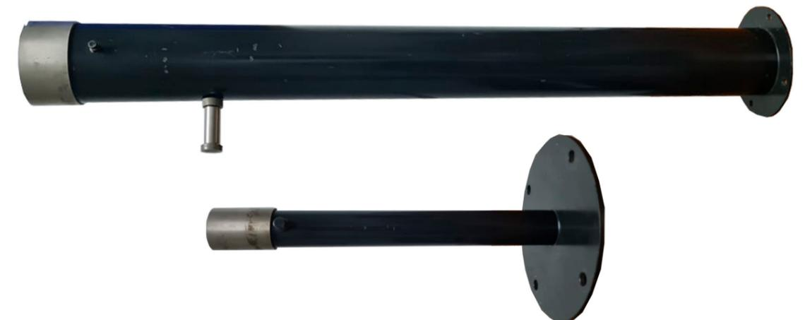
Figura 15. Tubos de diferente diámetro para la captación de distintas frecuencias. Fuente: (Elaboración propia, 2022).
