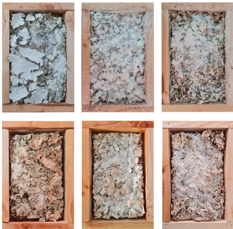
Figura 88. Cartón colonizado con micelio vivo en la parte superior, parte inferior micelio secado en horno listo para pasar al tamaño adecuado para la medición. Fuente: (Elaboración propia, 2022).
