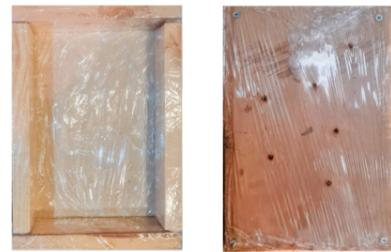
Figura 84. Moldaje con perforaciones. Fuente: (Elaboración propia, 2022).
