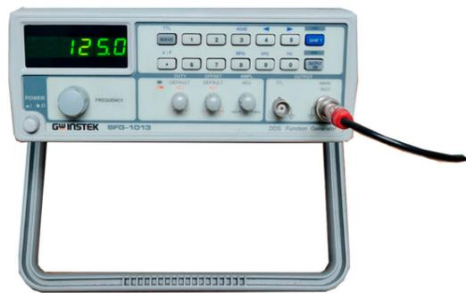
Figura 109. Oscilador de frecuencia establecido en la frecuencia de 125 Hz, en la parte superior se encuentra el monitor que muestra que las bandas laterales no están calibradas. Fuente: (Elaboración propia, 2022).
