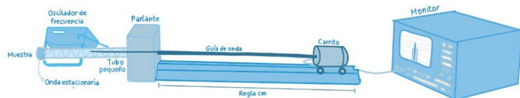
Figura 108. Tubo de diámetro de 29 mm de frecuencia altas. Fuente: (Elaboración propia, 2022).
