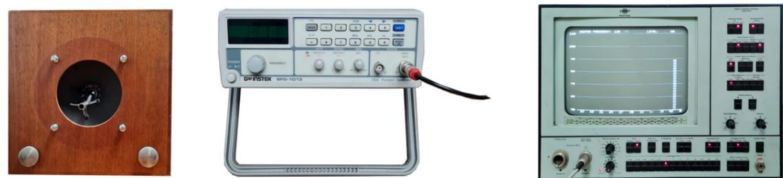
Figura 104. Parlante, oscilador de frecuencia, monitor que obtiene los datos, de izquierda a derecha respectivamente. Fuente: (Elaboración propia, 2022).
