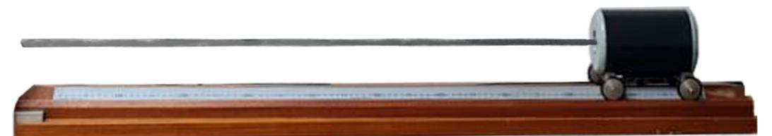
Figura 17. Carro que se introduce en el tubo en busca de la onda sonora. Fuente: (Elaboración propia, 2022).
