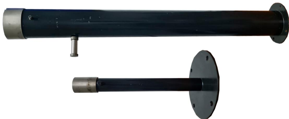
Figura 103. Tubos de diferente diámetro para la captación de distintas frecuencias. Fuente: (Elaboración propia, 2022).
