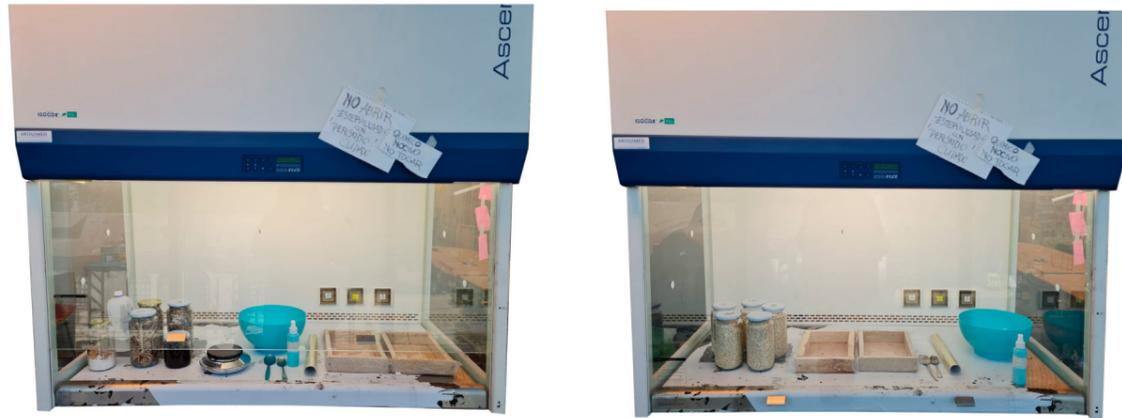
Figura 98. Cámara de flujo laminar con los implementos necesarios para la inoculación de los sustratos. Fuente: (Elaboración propia, 2022).
