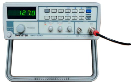
Figura 110. Oscilador de frecuencia establecido en la frecuencia de 127 Hz, en la parte superior se encuentra el monitor que muestra que las bandas laterales sí se encuentran calibradas. Fuente: (Elaboración propia, 2022).
