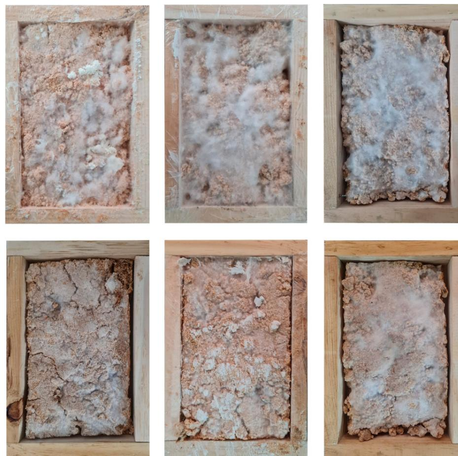
Figura 91. Aserrín colonizado con micelio vivo en la parte superior, parte inferior micelio secado en horno listo para pasar al tamaño adecuado para la medición. Fuente: (Elaboración propia, 2022).
