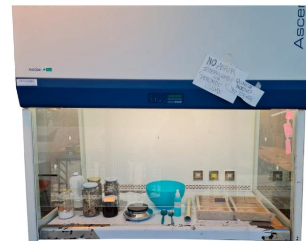
Figura 93. Cámara de flujo laminar usada en los distintos procesos de inoculación. Fuente: (Elaboración propia, 2022).
