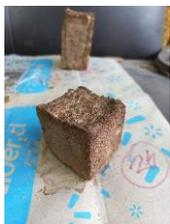
Ambos presentan densidades distintas, debido al volumen final del panel. Sin embargo, el que obtiene la mejor composición volumétrica corresponde al último aligerado, con una densidad de 244.7 kg/m<sup>3</sup>.
