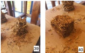
Se infiere que la capacidad de absorción de agua de la fibra deshidratada se ve alterada por el proceso previo de calor, por lo que independiente del aumento de humedad trabajada en la mezcla no mejora las condiciones morfológica del panel; siendo contrario a la observación de los ensayos más secos.
