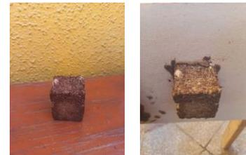
Al montarlo el panel queda fijo en la superficie, mostrando buenos resultados de la aplicación. Se establece otros posibles aligerados, siendo el mínimo de densidad probada de 198.8 kg/m<sup>3</sup>.
