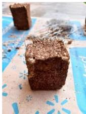
Obs: Se observan comportamientos más débiles en los paneles inferiores a 223.7 kg/m<sup>3</sup>. En general se desprenden secciones de las zonas más delicada, como las aristas y puntas del cubo.
