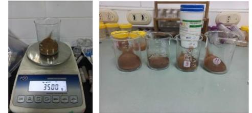
Se vierte agua en los recipientes hasta llegar a 250 ml. Se aplica 25 ml del dispersante hexametáfosfato de sodio, con el fin de neutralizar las cargas de las partículas e ir separado el agregado.
