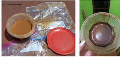
Al terminar el proceso de secado se observa una considerable disminución de volumen, quedando una costra de arcilla, esta se muele mediante mortero para ser utilizada como polvillo.
