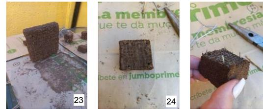
**Nota:** Para desmoldar los paneles de formato reducido, se cortan los alambres para así evitar dañar las muestras, acortando la distancia de retiro.
