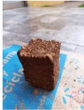
Obs: El ensayo 9, se rompe en el retiro de contención. Este presenta la menor densidad obtenida, de 193.1 kg/m<sup>3</sup>. presentando un rango en el que ya no es posible manipularlo.
