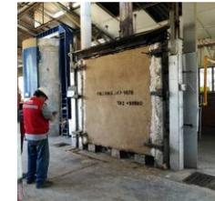
Fig. 8: Ensayo comportamiento al fuego
