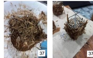
Obs: A pesar de deshidratar la fibra, no se observa una mayor absorción de humedad en mezcla, dejando residuos líquidos en ambos trabajos de fibra.
