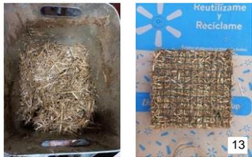
Obs: El preparado seco, dificulta el mezclado de los elementos, ya que los primeros granos en estar en contacto con el agua se agrupan, dejando el resto de paja totalmente seca. Se desmenuzan estos grumos húmedos manualmente, integrando todos los componentes para un conjunto homogéneo. Debido a esto, la preparación para este conjunto es más demorosa.
