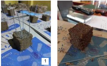
Se realizan paneles de manera controlada, realizado el total de pruebas, en distintos tiempos. Se van evaluando tras su secado para saber si se acerca el límite de aligerado, considerando en los resultados, la composición física del panel y peso final, calculando su densidad en  $\text{kg/m}^3$ .
