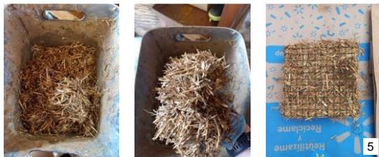
Obs: El aumento de la paja seca la muestra, por lo que se incorpora más agua que en las primeras pruebas, utilizando 300 ml para los 120 g de fibra.
