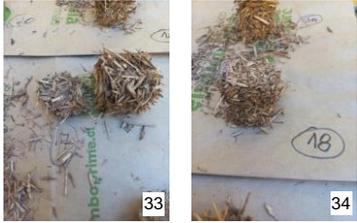
En la mezcla con menor presencia de humedad se aprecia un comportamiento mejorado con respecto a los paneles anteriores, intuyendo que la fibra deshidratada responde de distinta manera que la fibra normal debido a que se observa una mejor composición en la mezcla más seca, contraria a la situación dada con la fibra normal.
