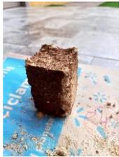
Los últimos paneles realizados (ensayos del 8 al 12), poseen las menores densidades, siendo factor del grado de compactación.
