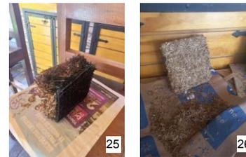
A causa de un incremento inesperado del calor del horno, se incendia una de las pruebas, correspondiente al grano mayor, siendo descartada para el análisis posterior.
