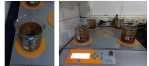
Luego se lleva a una máquina ultrasonido, que genera un movimiento a través de ondas, repercutiendo en la estructura interna de las partículas del agregado.
