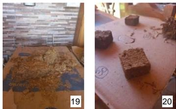
**Nota:** Debido a esto se evalúan los pesos de los paneles en distintas ocasiones, identificando si aún existe una pérdida de humedad, según el descenso de la masa cuantificada.
