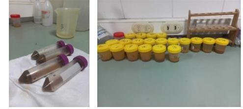
En el proceso de secado se requiere de una pipeta para ir retirando el agua cuidadosamente, se intenta no mover el recipiente, evitando que la arcilla de abajo se vuelva a dispersar en el agua. Ya retirando casi toda el agua, llega un punto en el que si se succiona lo más cercano al grano se pierde un resto de muestra, es por esto que se deja con una leve capa de agua sobre el aconchado.
