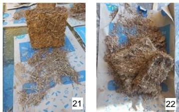
Obs: Durante la medición de peso, la prueba número 22 es la primera en desarmarse del secado pasivo, dejando en evidencia un centro aún húmedo. Se infiere que por falta de secado pierde la consistencia firme que estructura el panel, desmoronándose al momento de ser manipulado
