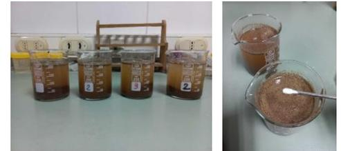
Se potencia la reacción de éste en el plato magnético, que consta de una máquina que genera un movimiento mecánico, la cual revuelve la mezcla mediante un imán que se le agrega al vaso y que gira según lo indicado en el aparato (600 revoluciones por min.); se deja actuar durante 10 min, y se procede a retirar los imanes.
