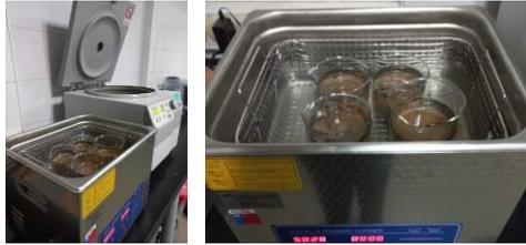
En paralelo, se prepara el resto de instrumentos a utilizar, se limpian los tubos plásticos de muestras con agua ultra pura, además de los recipientes plásticos en donde se deja finalmente reposar la mezcla.
