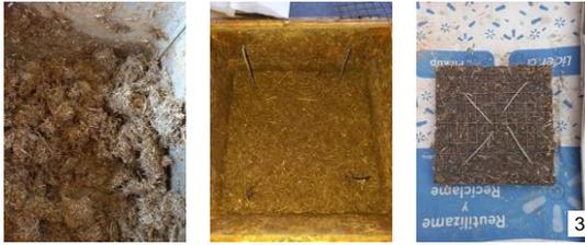
Obs: En la compactación al interior del moldaje, se identifica mayor homogeneidad de la mezcla en la fibra menor, siendo capaz de aglomerarse uniformemente.
