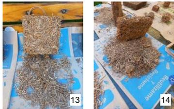
Obs: Para las pruebas de menor humedad, a pesar de su secado, en ambas versiones se ve un alto restante de fibra en la superficie de reposo, mayor a los desprendimientos de los paneles anteriores, siendo más frágiles al tacto, desmenuzándose constantemente en el desmoldado, traslado y pesado.
