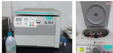
Esta acción permite concentrar las partículas inferiores a 2 micras en el líquido flotante, el resto que es de tamaño superior queda aconchado en el fondo, siendo materia que no se utilizará.
