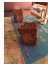
Utilizando la cantidad mínima de arcilla posible de medir con los implementos utilizados, (0.1 g) se observa una buena consistencia, presentando la menor densidad de todos los paneles desarrollados, siendo de 196.6 kg/m<sup>3</sup>.
