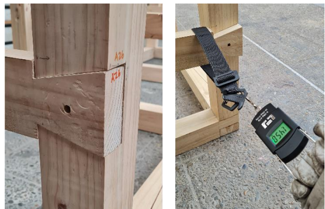
Fig.10: Desarmado Unión A26 y utilización de pesa más cinta. Elaboración propia
