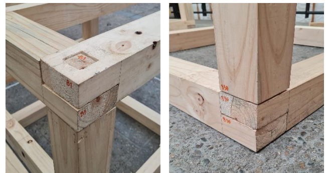
Fig.13: Comparación uniones de caja y espiga B1 y B30. Elaboración propia.
