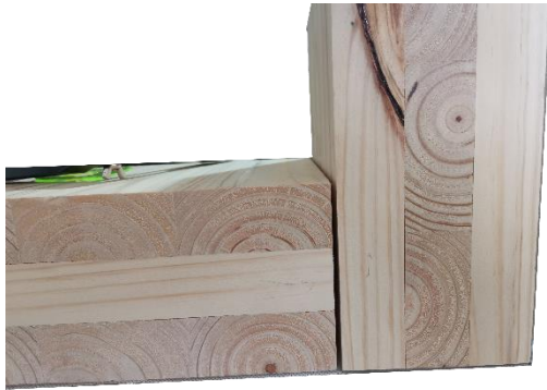
Figura 48: Tolerancia 2mm en pieza 3' ángulo corte en 90°. Nota. Elaboración propia, 2022
