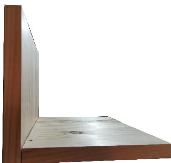
Figura 46: Tolerancia 2mm en pieza 1' ángulo corte en 90°. Nota. Elaboración propia, 2022
