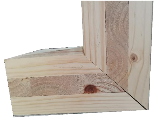
Figura 49: Tolerancia 2mm en pieza 3' ángulo corte en 45°. Nota. Elaboración propia, 2022
