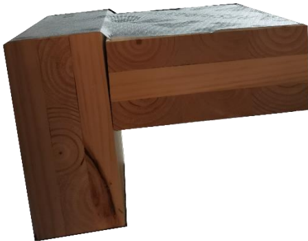
Figura 35: Posición 3 piezas de 3' unión 90°. Nota. Elaboración propia, 2022
