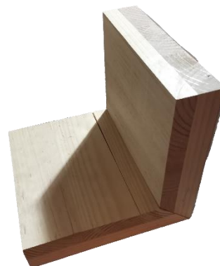
Figura 32: Posición 1 piezas de 2' unión 45°. Nota. Elaboración propia, 2022
