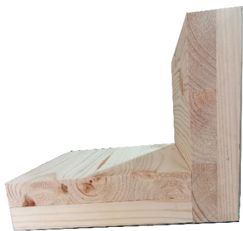
Figura 31: Posición 1 piezas de 2' unión 90°. Nota. Elaboración propia, 2022
