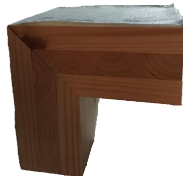
Figura 36: Posición 3 piezas de 3' unión 45°. Nota. Elaboración propia, 2022
