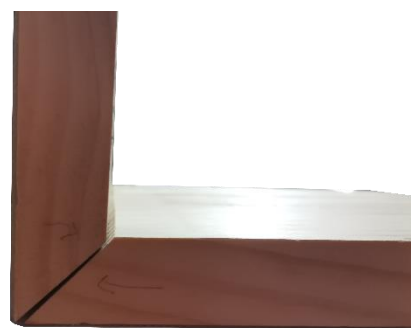
Figura 47: Tolerancia 2mm en pieza 1' ángulo corte en 45°. Nota. Elaboración propia, 2022
