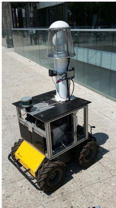
Figura 3.2: Disposición de los sensores montados sobre un vehículo eléctrico "Husky".
