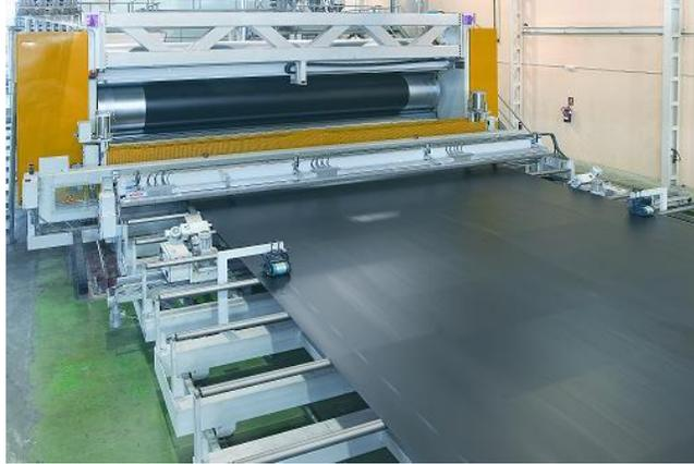
Figura 4.10: Producción geomembrana, extrusión plana.
