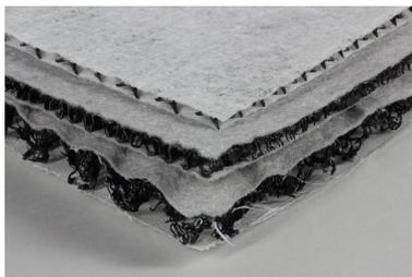
Figura 4.3: Geocompuestos.
