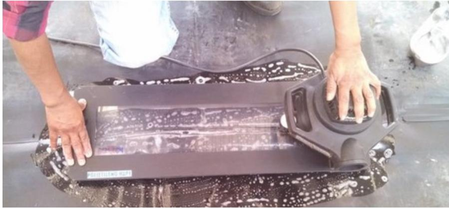
Figura 4.25: Prueba de vacío.
