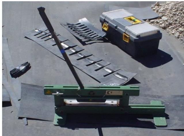
Figura 4.23: Ensayo destructivo en geomembrana.
