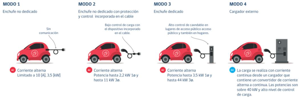
Figura 2.4: Modos de Carga según norma IEC61851 (Fuente: Plataforma de Electromovilidad [18]).
