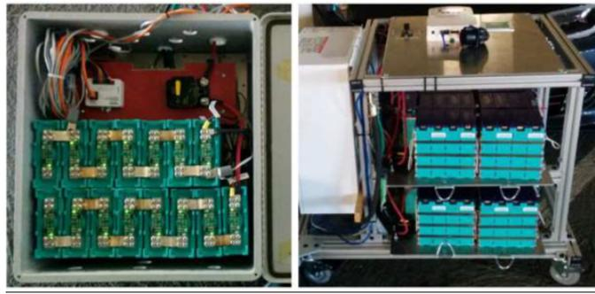
Figura 2.23: Baterías modulares móviles para carga de EV en emergencias (Fuente: *Demonstrating Plug-in Electric Vehicles Smart Charging and Storage Supporting the Grid* [39]).
