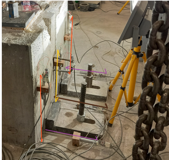
Figura 3.21: LVDT en las fundaciones
