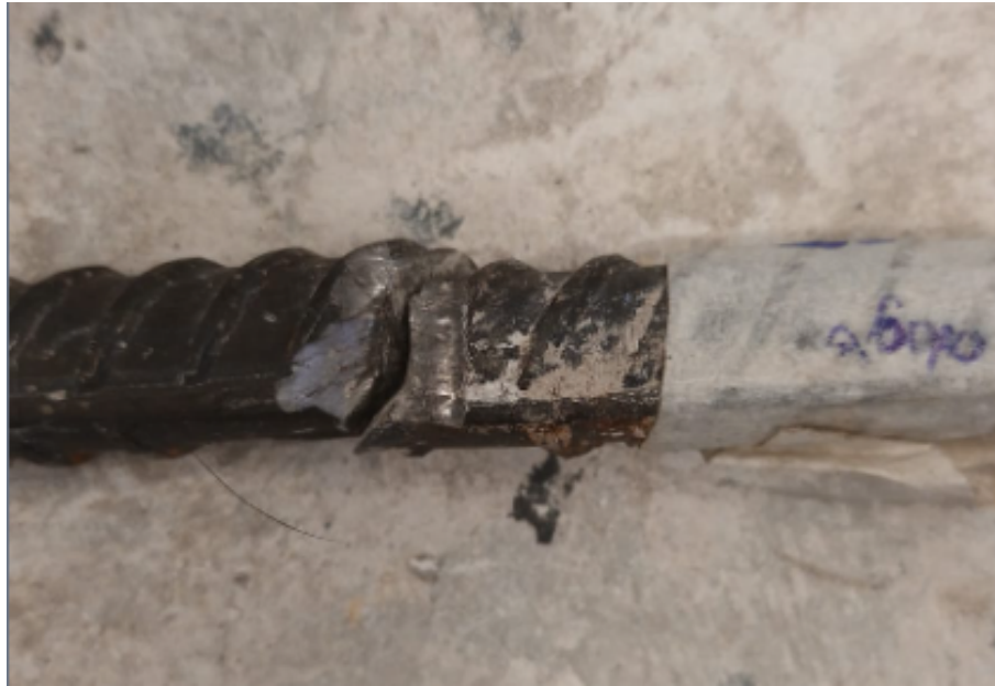
Figura 4.28: Daño por taladro en barra de 12 mm de lado sur
