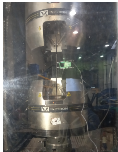
Figura 3.6: Montaje ensayo tracción barras
