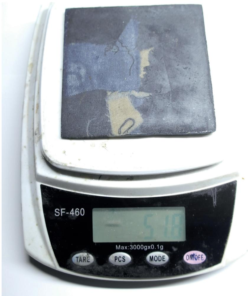
Para la elaboración de la muestra se utilizaron 50 gramos de resina epóxica de dos partes, en conjunto con 50 gramos de mezclilla. Para rellenar el molde bastaron 20 g. de mezclilla ya empapada en resina, por lo que quedaron 30 g. de mezclilla sin utilizar. Posterior a la aplicación de presión al molde se perdieron 27,7 g. de resina, la cual fluyó fuera del contenedor. Se establece entonces que para 20 g. de mezclilla se necesitan 47 g. de resina, al menos utilizado el método aquí demostrado.
