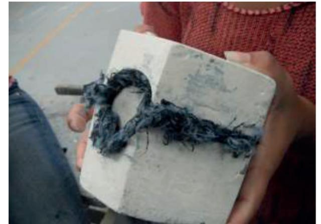
Figura 16: Mezclilla licuada con agua, mezclada con engrudo y extracto de linaza, comprimido en moldes de yeso, elaborada por Rossa et al., 2015.
