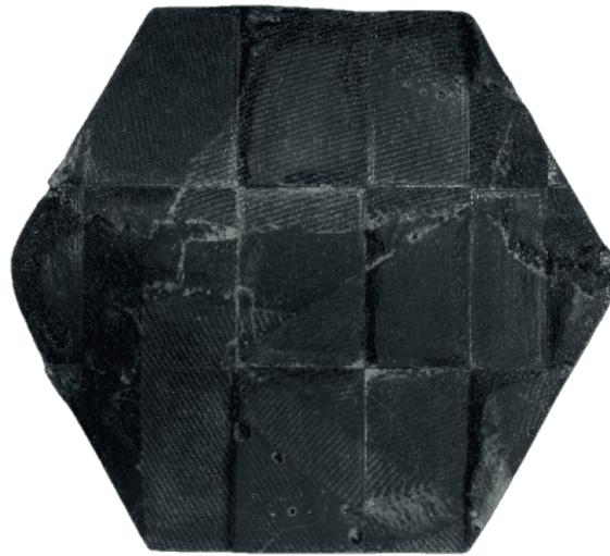
Para probar la factibilidad de creación de piezas más complejas, se crean moldes con diversas texturas aplicadas. A través del desarrollo de esta investigación se comprobó que la mezclilla debe estar totalmente empapada y compactada, para evitar burbujas de aire que afectan la calidad de la pieza. Este nivel de dificultad aumenta considerablemente con la utilización de moldes más complejos, ya que mientras más pequeños son los detalles, mayor posibilidad hay de que se formen estos vacíos.
