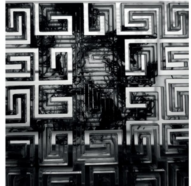
Figura 23: Material compuesto de carácter plano, cortado con láser, en el que se pueden apreciar zonas con mayor concentración de fibras que no pudieron ser cortadas de manera correcta, elaborada por Gómez et al., 2019.
