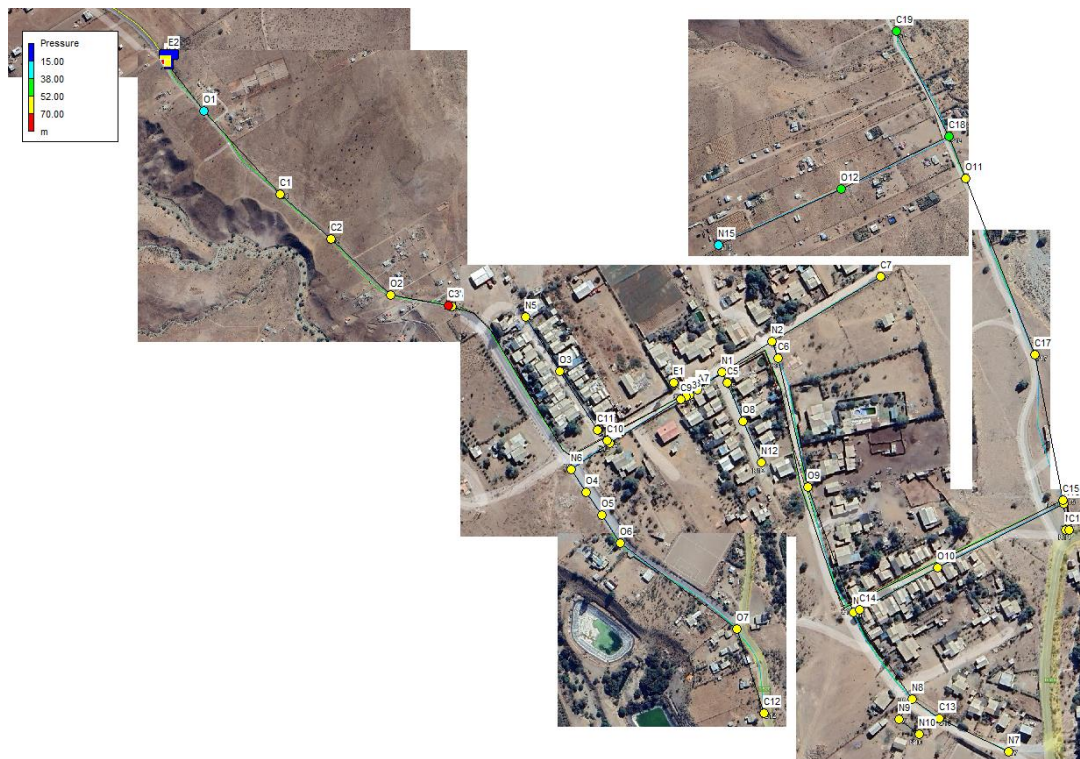
Figura 19. Distribución actual de la red de distribución en EPANET, Villorrio El Talhuén.
