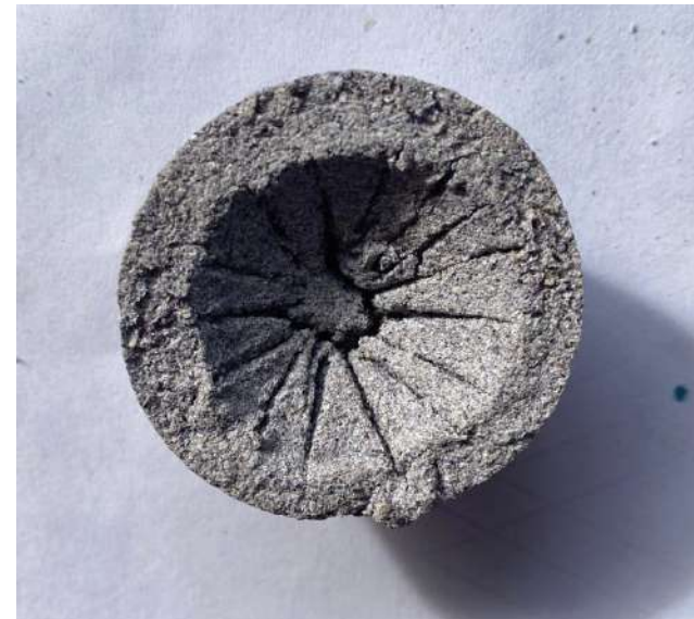
Figura 86, grietas en el material. Elaboración propia.
