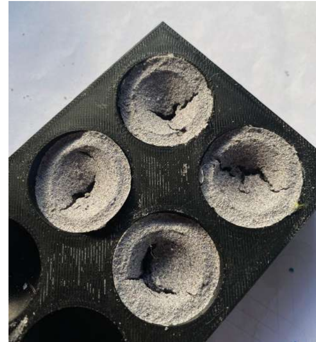
Figura 85, grietas. Elaboración propia.
