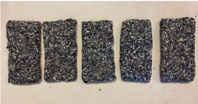
Figura 15. Probetas ensayo flexión. Elaboración propia
