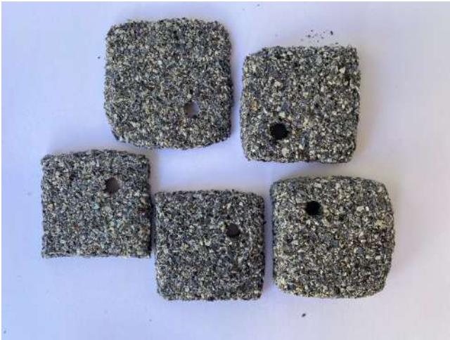
Figura 56, Resultado lijado de agua grano 400 . Elaboración propia
