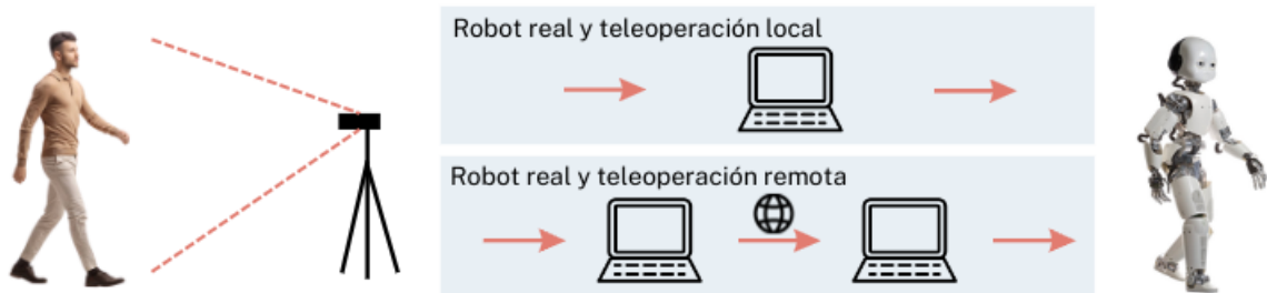
Figura 5.4: Montaje experimental para experimentos del sistema completo con resultados en el robot real.
