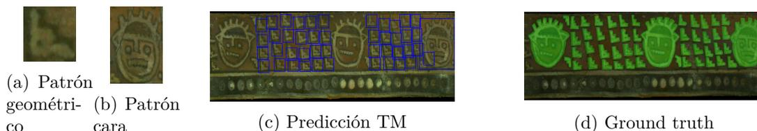
Figura 5.1: Ejemplo de resultado del algoritmo Template Matching. Imagen con 2 patrones. El primer patrón (a) corresponde a un objeto geométrico que tiene un buen resultado en la detección a pesar de que su tamaño es pequeño y que su forma cambia. El segundo patrón (b) corresponde a una figura compleja debido a los detalles y a que su forma varía levemente.
