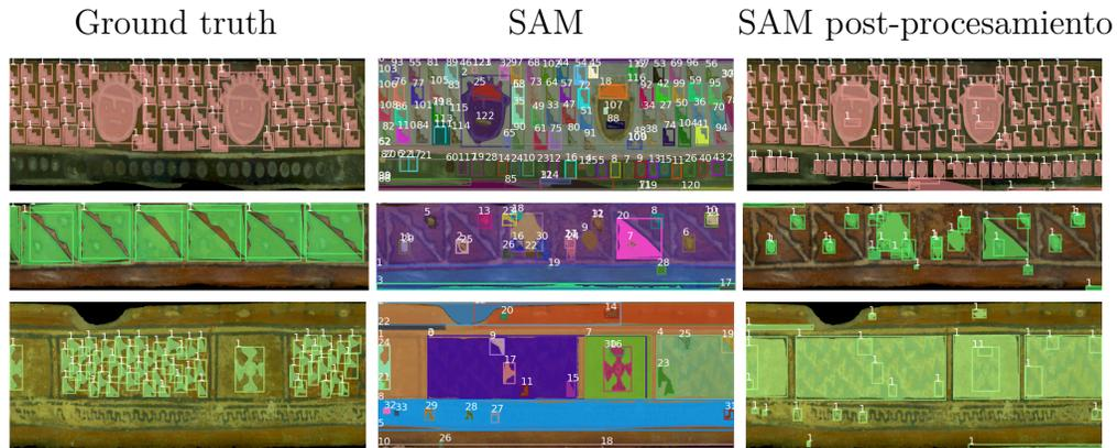
Figura 5.4: Ejemplo de detección realizada por SAM. De izquierda a derecha, ground truth de RPT3DS, resultado de la detección automática realizada por SAM y resultado del post-procesamiento eliminando áreas outliers y asignándoles la misma etiqueta a cada objeto detectado.
