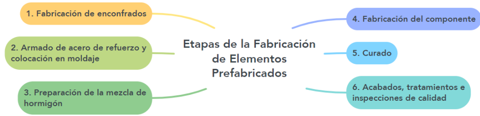
Figura 3.12: Etapas de la fabricación de elementos prefabricados de hormigón armado. Fuente: Elaboración propia.
