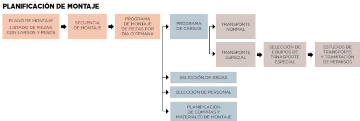
Figura 2.5: Planificación para montaje de elementos prefabricados de hormigón. Fuente: Hormigón al Día
