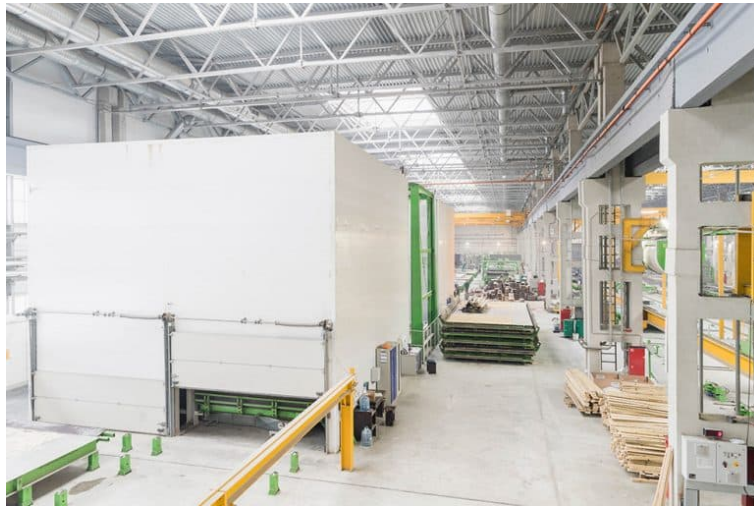
Figura 3.15: Cámara de curado automático y control de humedad. Fuente: Página web Elematic Precast Technology.
