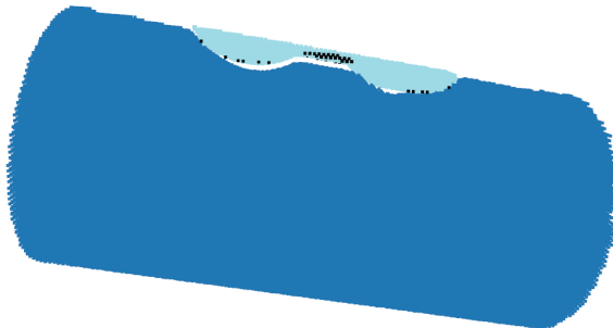
Figura 3.6: Voxels coloreados según la etiqueta obtenida con el algoritmo DBSCAN.
