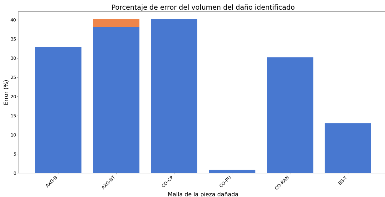
Figura 4.26: Error porcentual en el volumen del daño identificado para modelos de la base de datos sintética, utilizando la diferencia de volumen entre las mallas geométricas de las piezas original y dañada como referencia.
