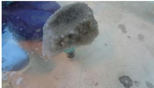
**Figura 10. Arena de cuarzo biomineralizada en el punto de inoculación de los modelos de acuífero.** Se muestra una porción de arena de cuarzo biomineralizada que se ubicó en el punto de inoculación de los modelos inoculados. En zonas más distantes al punto de inoculación, no se observó la formación de aglomerados de arena similares al de la imagen.
