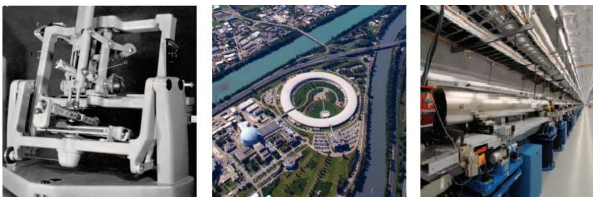
Figura 8. (Izquierda) Difractómetro lineal Hilger-Watts, usado para ayudar resolver la estructura de la lisozima en 1965, por medio de la recopilación de datos. (Centro) La primera fuente de sincrotrón de tercera generación de rayos x. (Derecha) Parte del proyecto Láser Europeo de Electrones Libres y Rayos X o XFEL por sus siglas en inglés.
