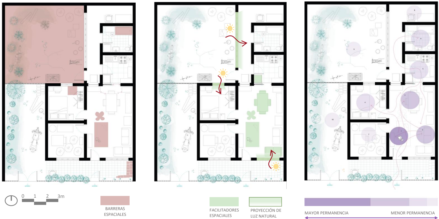
Fig. 47: Planimetría barreras, facilitadores y de flujos de permanencia de izquierda a derecha. Elaboración propia
